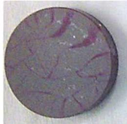
Abb. 29: Thermoschock einer keramischen Probe aus den Laborübungen des ISFK.
