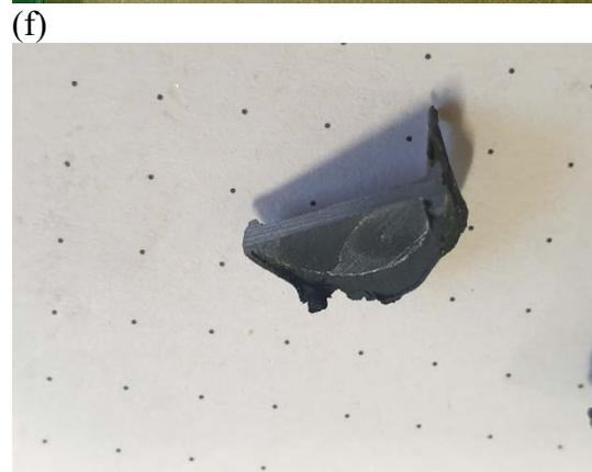
Abb. 39: Unterschiedliche Klebstoffsorten im Biegeversuch. (a) bis (c) Klebstoff B, (d) Klebstoff A und (e) bis (f) ist Klebstoff C.
