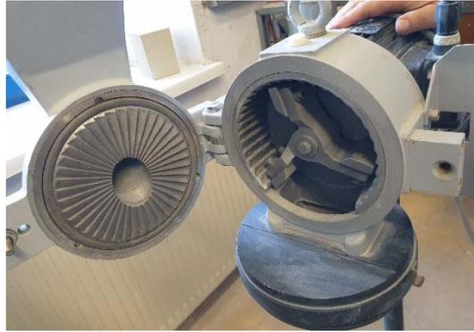
Abb. 7: Schlagkreuzmühle für die Zerkleinerung des gebrannt Rücklaufs
