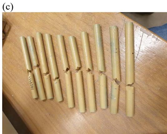
Abb. 37: In (a) dargestellt eine Probe nach 3PB, in (b) eine 4PB und unter (c) sieht man mehrere Proben welche alle gültig gebrochen sind.
