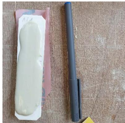
Abb. 8: Herstellprozess des Tonerde-Zement-Klebers
