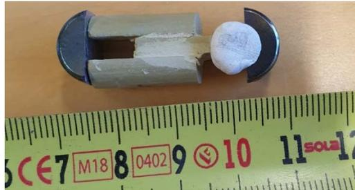
Abb. 26: Prüfkörper mit Hilfsmittel zur definierten Krafteinleitung
