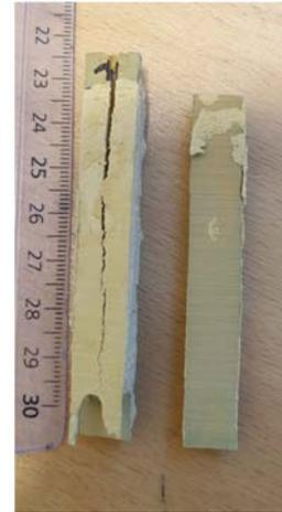
Abb. 19: Probenvariante A) welche mittig gebrochen wurde, ohne die Klebefläche zu zerstören. (a) und für die Analyse nachträglich zerteilte Probe (b)
