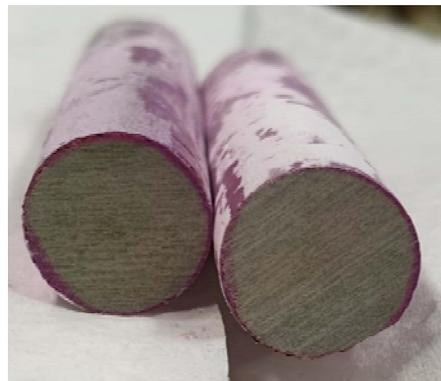
Abb. 41: Mit 520°C abgeschreckte Probe, behandelt mit Fuchsin, ohne Rissnetzwerk.
