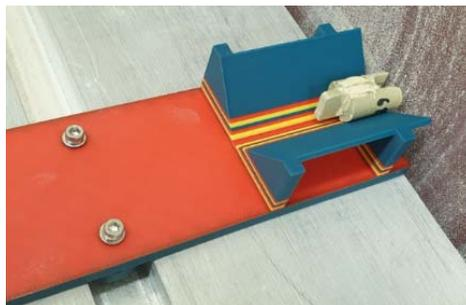
Abb. 23: Probenaufnahme an der Schleifmaschine.
