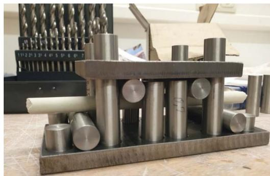
Abb. 15: Prüfvorrichtung zur 4-Punkt Biegeprüfung. Der Durchmesser der Auflagerr- und Lastrollen beträgt 14 mm, in weiß ist eine Probe aus dem Grundmaterial zu erkennen.
