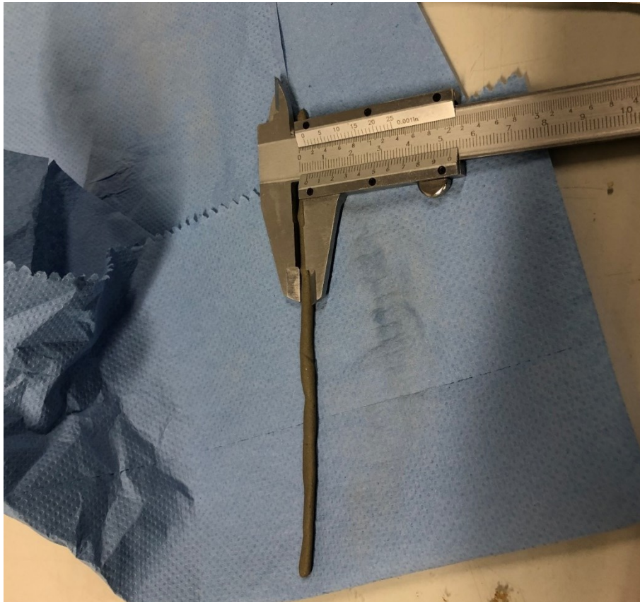
Abbildung 24: Ermittlung der Ausrollgrenze, herstellen von 3mm Rollen bis diese zu bröckeln beginnen
