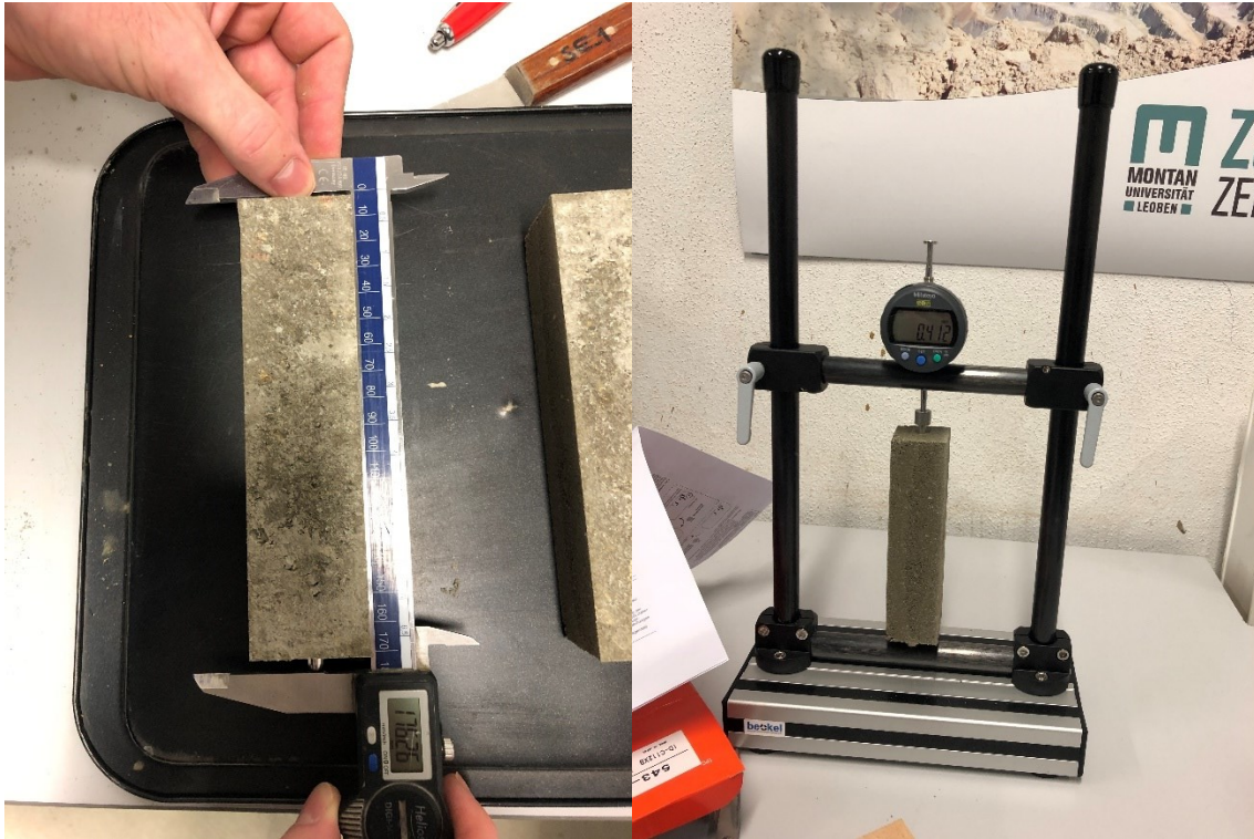
Abbildung 26 links: Messung der Bezugslänge mit einem Messschieber; rechts: Messung der Initialmessung mit einem Schwindmessgerät
