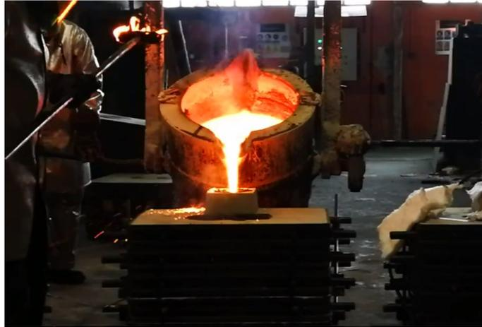
Abbildung 3.18: Abguss der Probe A-07.
