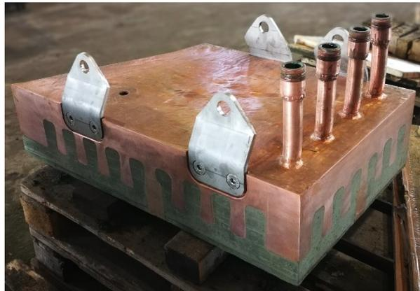
**Abbildung 1.1: Kupferkühlelement mit eingegossenen Rohrschlangen und kombinierter Feuerfestzustellung.**
