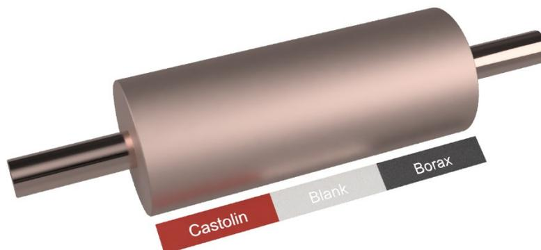
**Abbildung 3.8:** Modell des Probenkörpers für die Gussversuche mit dem eingegossenen Rohr in der Mitte; die Beschriftungen beziehen sich auf die Oberflächenvorbereitung des Rohrs vor dem Guss.
