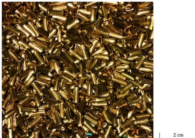
Abbildung 3.7: Primärkupfer, das für die Schmelzen verwendet wird.
