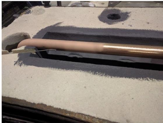
Abbildung 3.20: Vorbereitete Oberform mit eingelegtem Rohr, die linke Hälfte des Rohrs ist sandgestrahlt, die rechte geschliffen mit K60.
