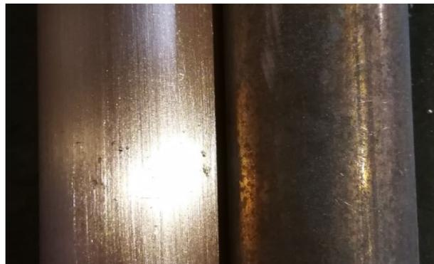
Abbildung 2.1: links: metallisch blankes Rohr, rechts: oxidiertes Rohr.
