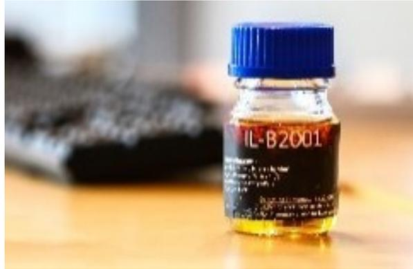
**Abbildung 1.7: Wasserfreie Kühllösung - Ionische Flüssigkeit IL-B2001 (Quelle: Mettop GmbH).**
