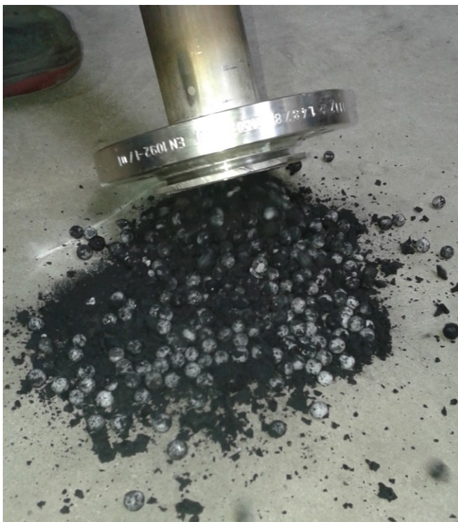
Abbildung 2-5: Alter Druckbehälter mit Inertkugelschüttung und Kohlenstoffablagerungen
