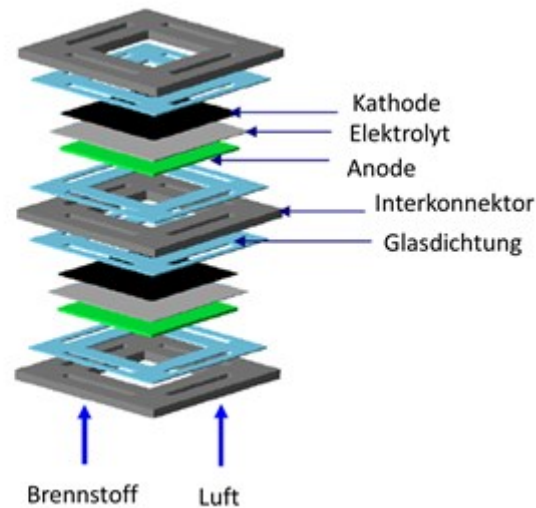
Abbildung 3-3: Planarer Aufbau einer Brennstoffzelle [9]
