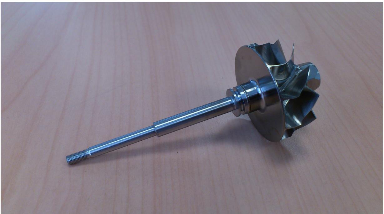
**Abb. 5.1:** Turbinenläufer aus der TNM<sup>TM</sup>-Legierung mit Stahlwelle [23].
