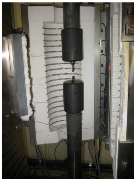
**Abb. 3.2:** Zugprüfmaschine mit Heizeinrichtung auf Basis einer Widerstandsheizung.
