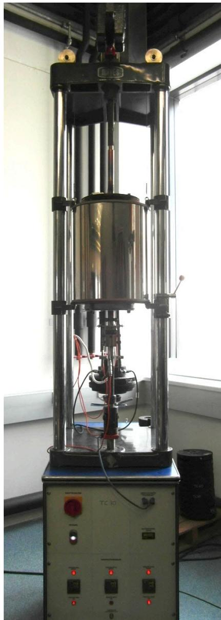
**Abb. 3.3:** Kriechversuchsanlage des Typs TC30 der Firma Mayes.
