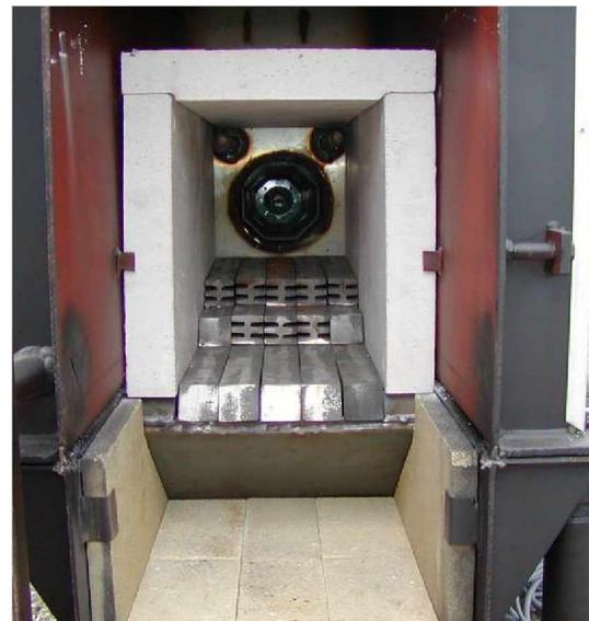
Abbildung 5.8.: REKA Biomassekessel HKRST-FSK 20 im Schnittbild (links) [134] und Ansicht des Brenners (rechts) [135].
