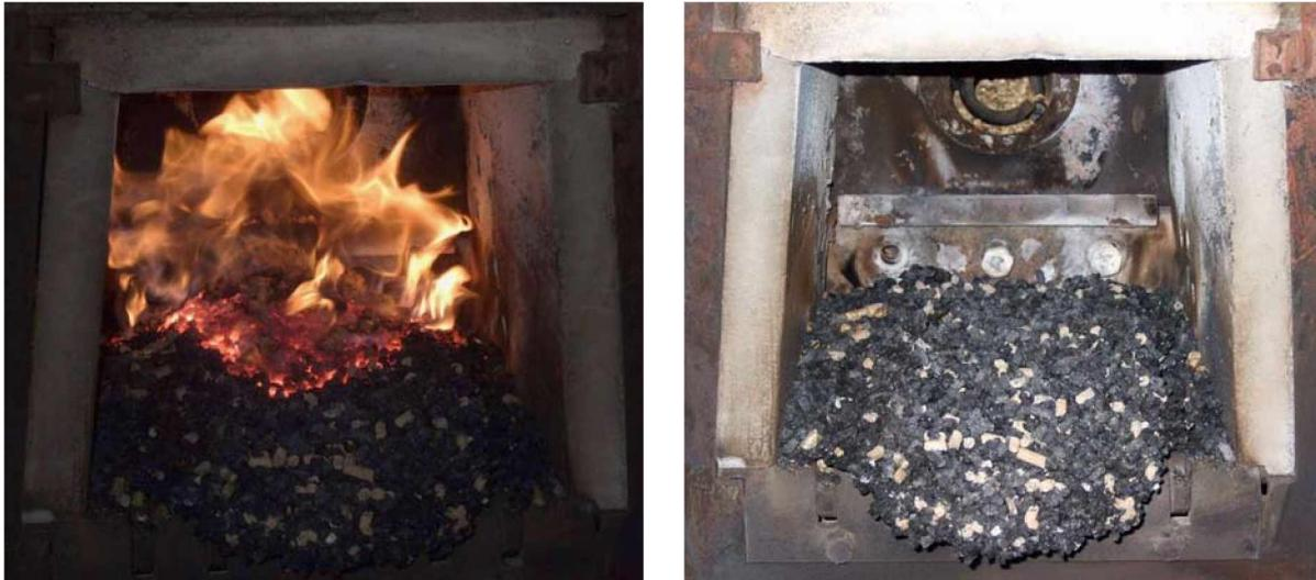
Abbildung 8.4.: Verbrennung von Weizenpellets am Rost des Heizkessels der Firma Verner während der Betriebsphase (links) und nach dem Abstellen (rechts). In beiden Bildern ist deutlich die oberflächliche Verkrustung zu sehen.
