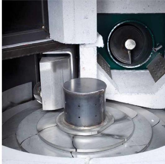
Abbildung 5.30.: Drehtrost des TDS POWERFIRE der Firma KWB mit Einschubschnecke und Vorbrennkammer [179].
