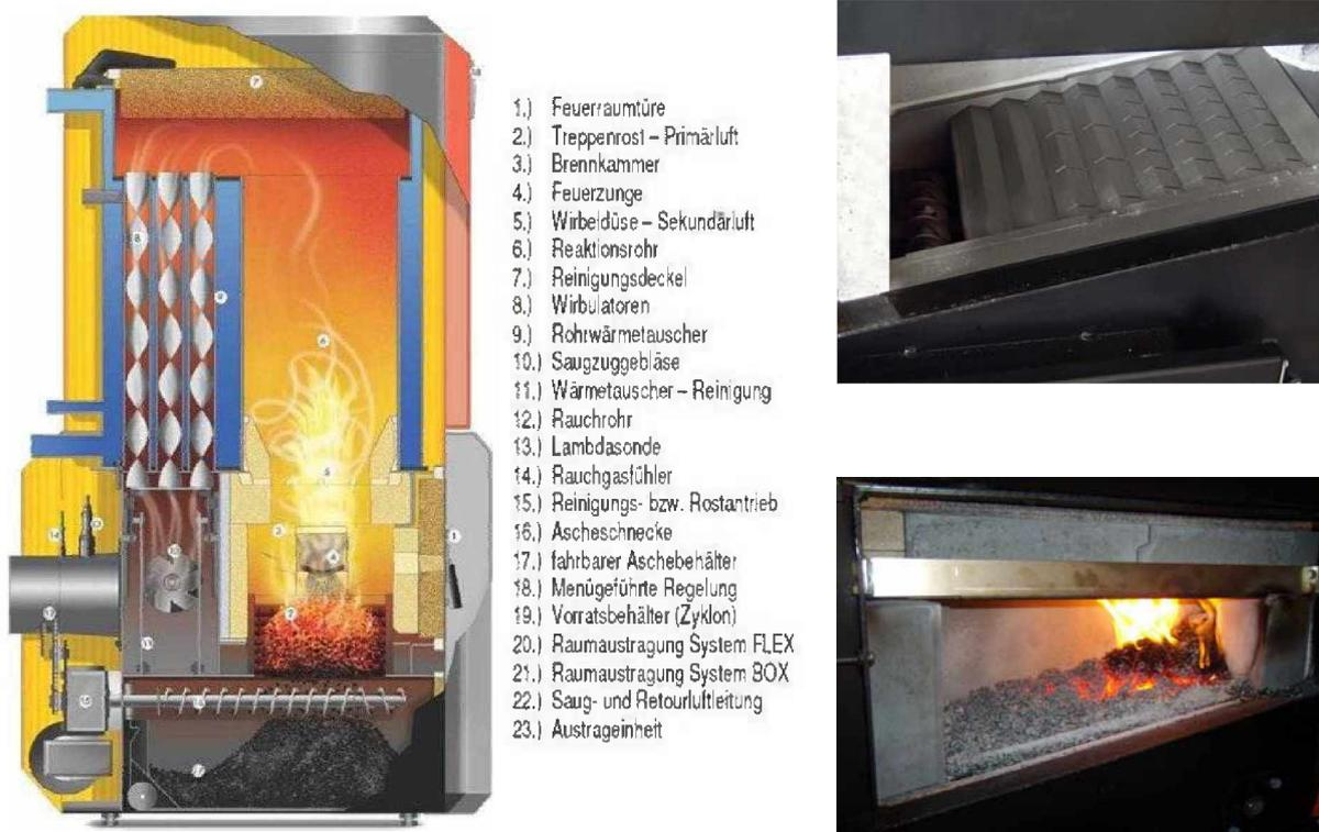
Abbildung 5.1.: Guntamatic Energiekornfeuerung Powercorn im Schnitt (links) [118], Treppenrost mit Primärluftschlitzen (rechts oben) und Flambild mit Energiekorn (rechts unten) [119].
