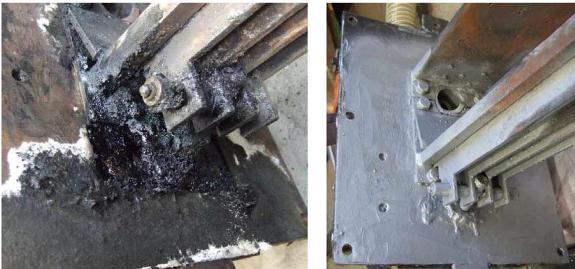
Abbildung 9.3.: Teerartige Verkrustungen unter dem Rost (links), Beschichtung mit technischem Schmierstoff auf Aluminiumbasis - ANTI-SEIZE (rechts).
