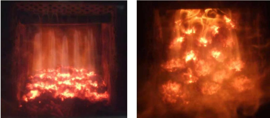
Abbildung 9.1.: Flammenbilder der sechsten Version des Brenners: Verbrennung von Weizenstrohpellets Charge 2 (links) und Holzpellets (rechts).
