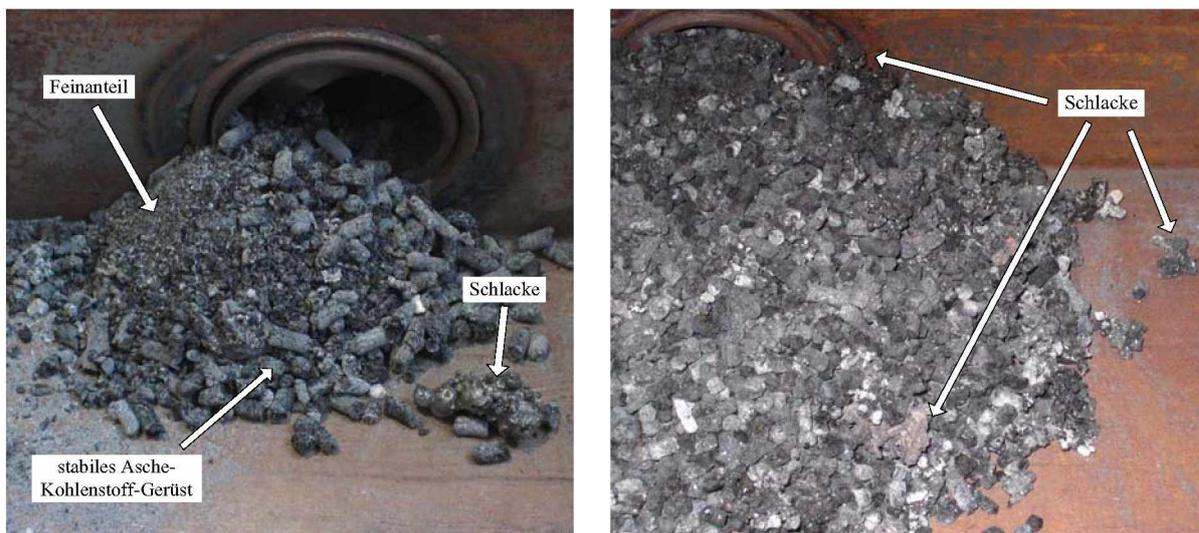
Abbildung 9.12.: Asche im Aschebehälter bei Versuchen mit Weizenstrohpellets der Charge 2.
