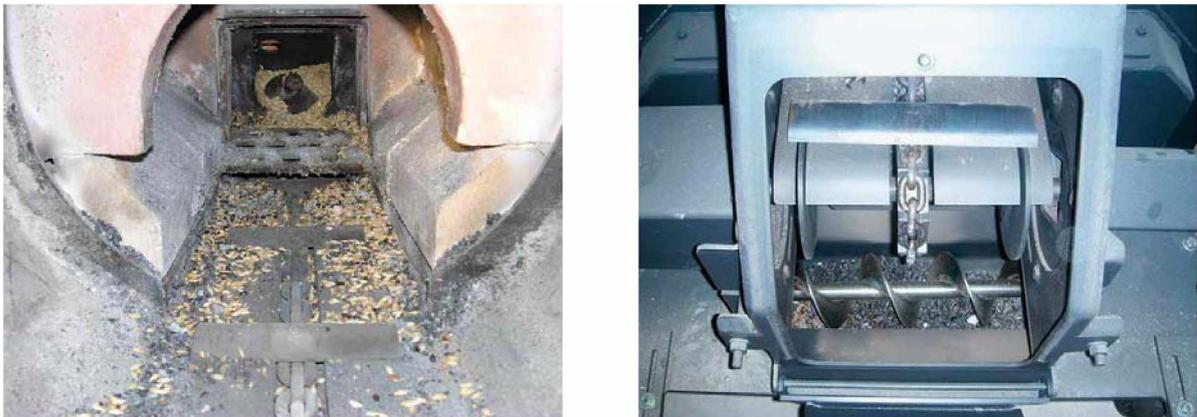
Abbildung 5.3.: HEIZOMAT RHK-AK Brennraum mit Ketten-Entaschung (links) [126] und Ascheaustragung (rechts) [125].
