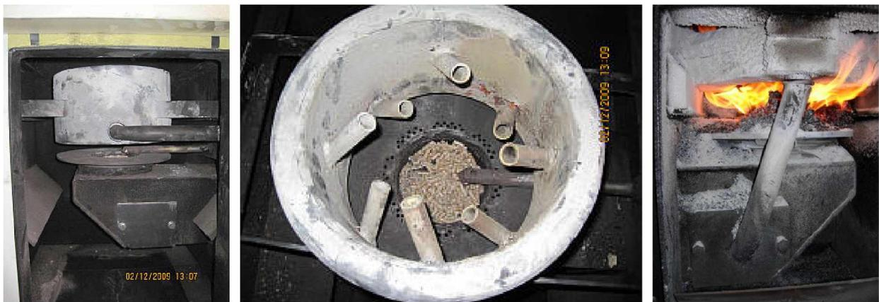
Abbildung 5.15.: Brenner des BENEKOV-Heizkessels: seitliche Ansicht (links), Sekundärluftdüsen (mitte) [150], Brennteller bei Betrieb (rechts)[151].
