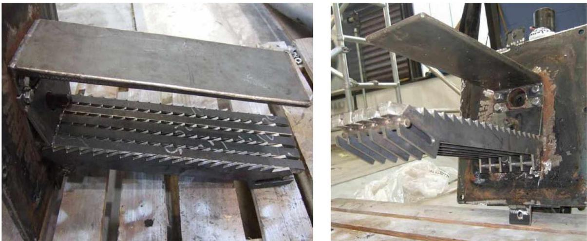
Abbildung 8.19.: Rost der sechsten Version des Vorschubrostes seitlich (links) und schräg von unten (rechts).
