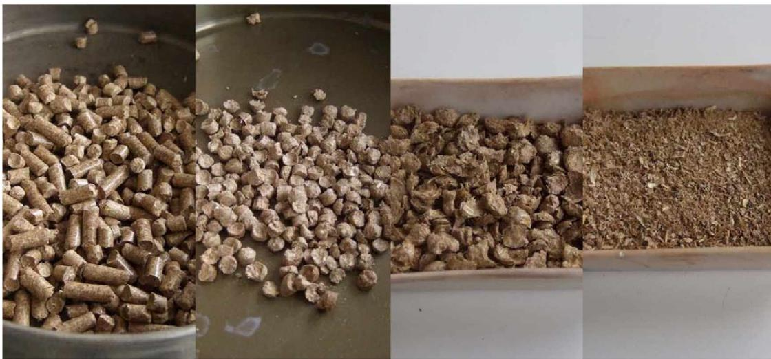
Abbildung 7.1.: Fraktionen des Brennstoffs WP Ch2 (von links nach rechts): Pellets mit einer geometrisch zylindrischen Form ab 3 mm Länge, gebrochene Pellets ohne streng zylindrischer Form mit einer Länge von 4 mm bis Pelletsdurchmesser (6 mm), Feinanteil mit 1 bis 4 mm und Feinanteil < 1 mm.
