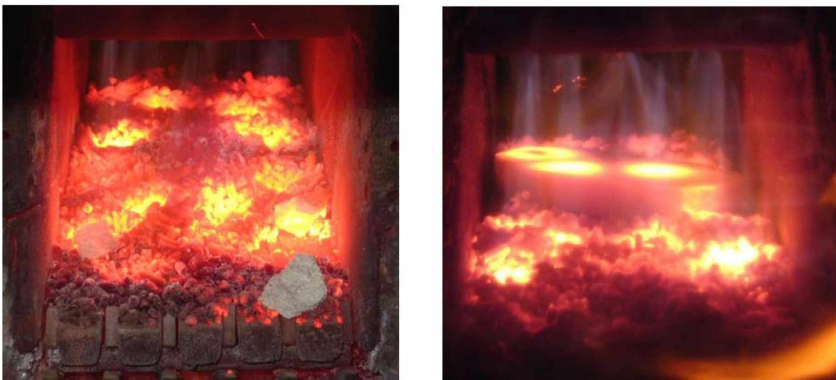
Abbildung 9.37.: Messung der Verweilzeit des Brennstoffs am Vorschubrost: Links durch zwei kleine Bruchstücke von Feuerleichtsteinen beim Versuch mit Holzpellets (V8), rechts ein größerer Teil eines Feuerleichtsteins beim Versuch mit Miscanthuspellets (V7).
