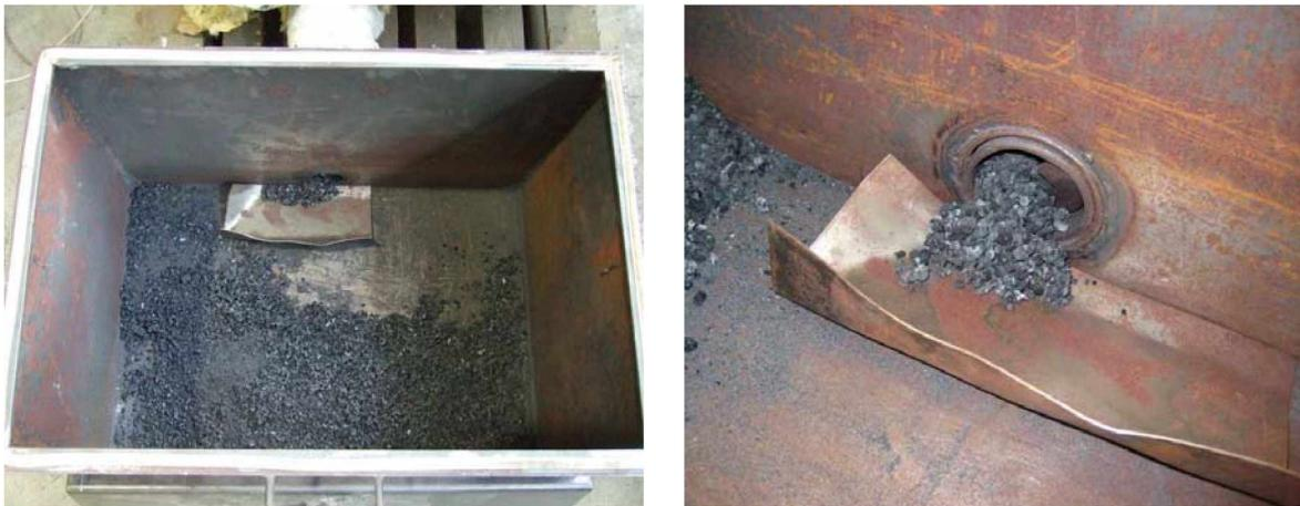
Abbildung 9.13.: Probenahme der Asche im Aschebehälter.
