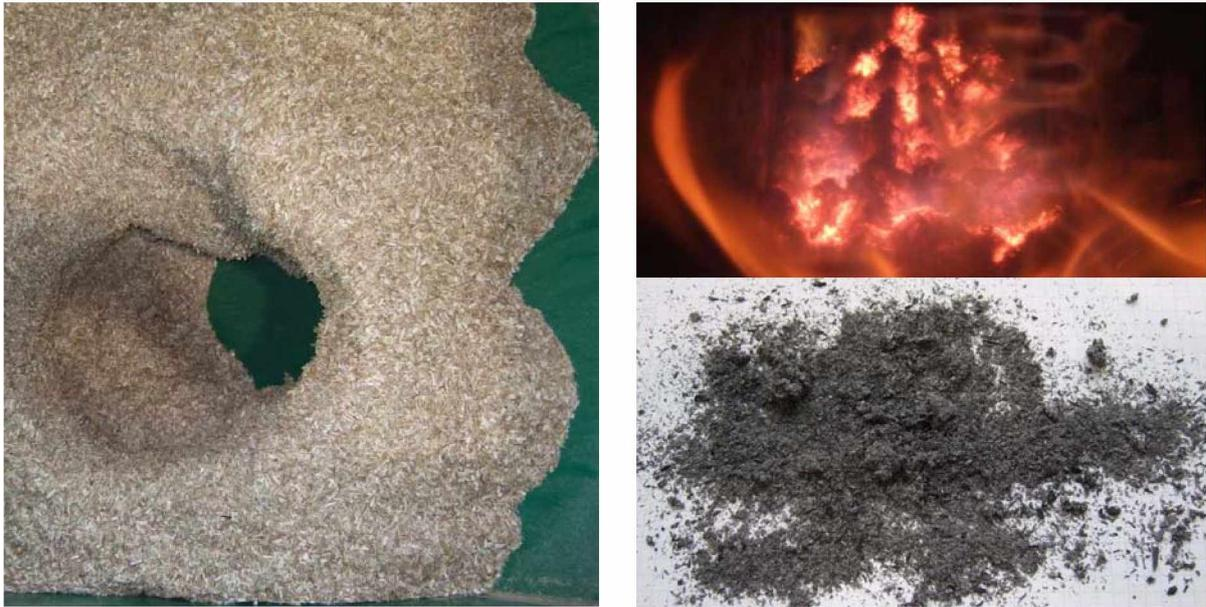
Abbildung 9.6.: Brückenbildung im Vorratsbehälter mit Miscanthus-Häckselgut (links), Flammenbild (rechts oben) und Asche (rechts unten) desselben Brennstoffs.
