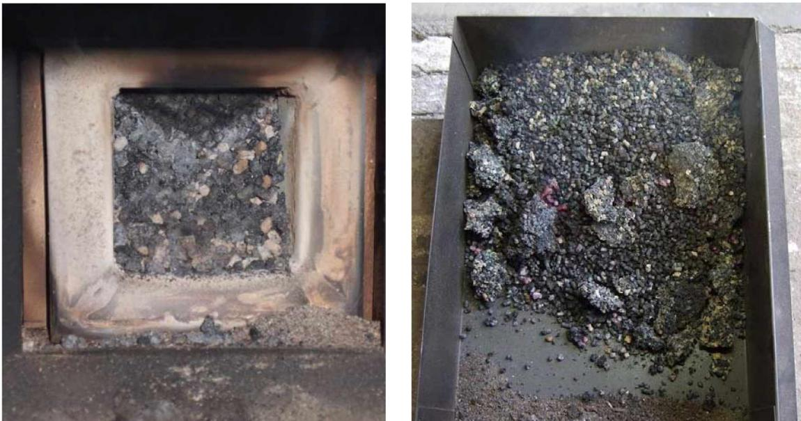
Abbildung 8.3.: Mit Asche und verschlackter Asche verstopfter Brenner (links), Verbrennungsrückstand mit verschlackten Bestandteilen und teilverbranntem Brennstoff (rechts).
