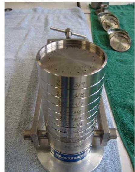
Abbildung 6.7.: Schnitt durch eine Stufe des BLPI (links), Stufen des BLPI mit Sicht auf die Düsenplatte der Stufe 9 (rechts)
