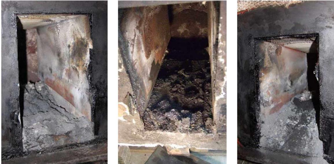
Abbildung 9.4.: Ablagerungen unter dem Rost nach Versuchen.
