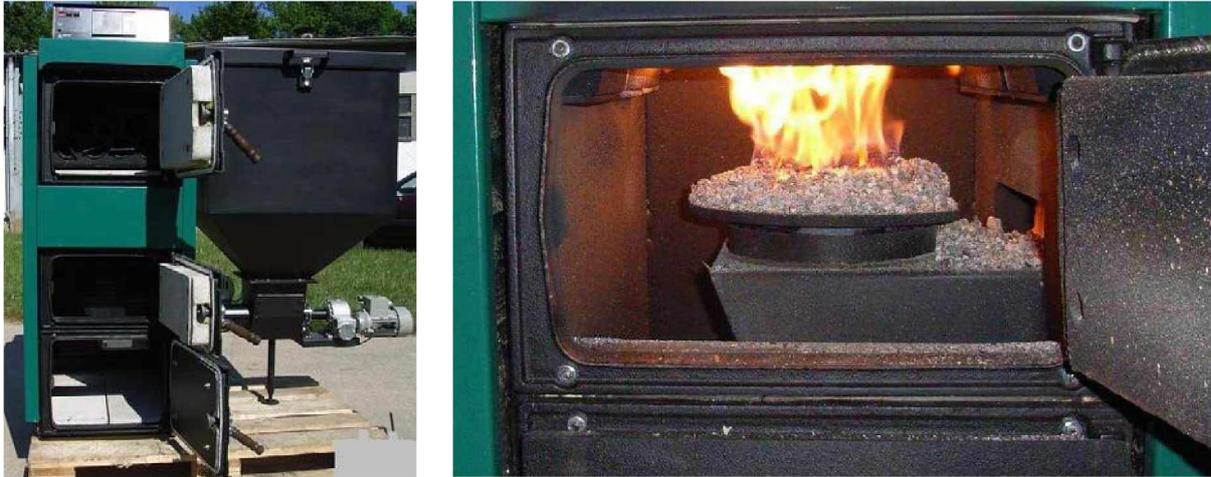
Abbildung 5.22.: AGRISERVE Pelletsessel in Vorderansicht (links) und Brenner mit Unterschubfeuerung (rechts) [165].
