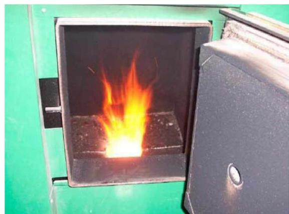
Abbildung 5.7.: Brennkammer des BIOKOMPAKT AWK mit wannenförmiger Retorte aus Schamotte mit Primärluftauslässen (links) und Flamme beim Austritt aus der schamottierten Wirbelkammer in die Ausbrandzone, Versuch mit Roggen bei Volllast, 45 kW [132].
