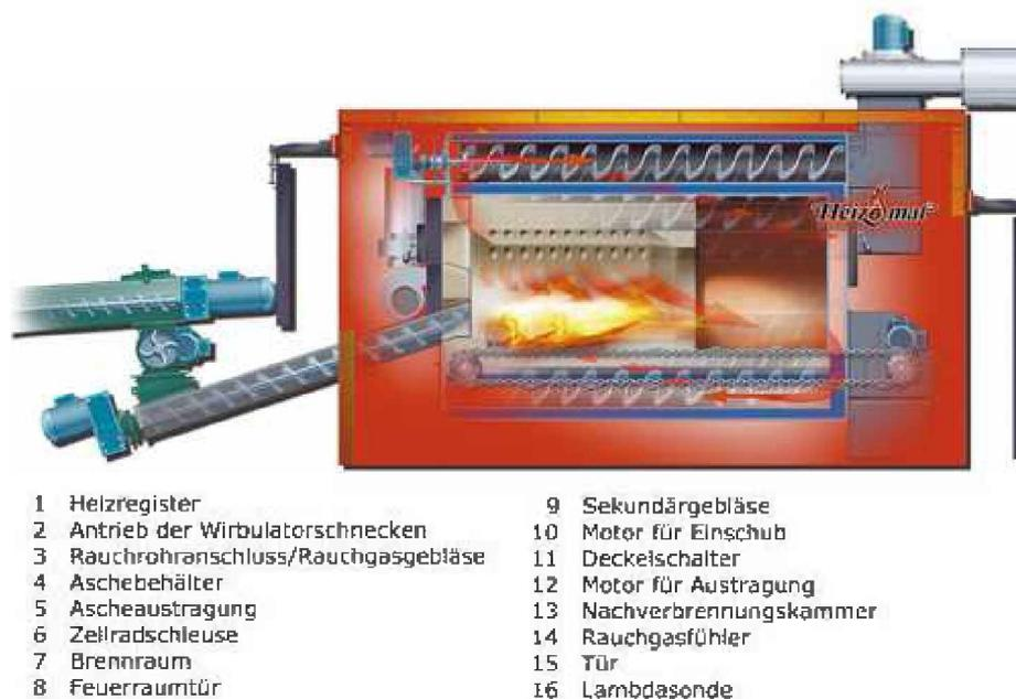
Abbildung 5.2.: Schema des HEIZOMAT RHK [125].
