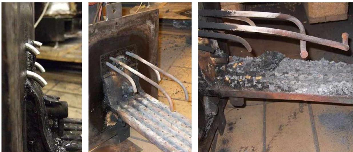
Abbildung 8.17.: Kleine Düsen an der Brennerrückwand (links), mittlere und lange Düsen (mitte) und gewundene Düsen (rechts) zur Einbringung von Luft auf das Brennstoffbett. Im mittleren Bild sind die mit den Nägeln verschlossenen Düsen deutlich zu sehen.
