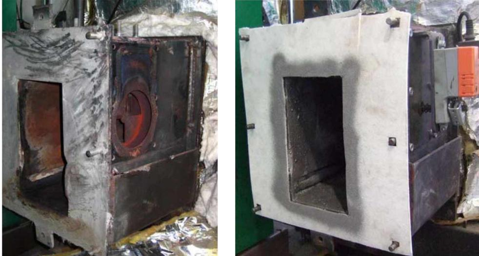
Abbildung 9.2.: Abdichtung der Brennerrückwand; Anti-Size-Beschichtung, demontierte Sekundärluftklappe (links), Feuerfestmatte mit ANTI-SEIZE-Beschichtung (rechts).
