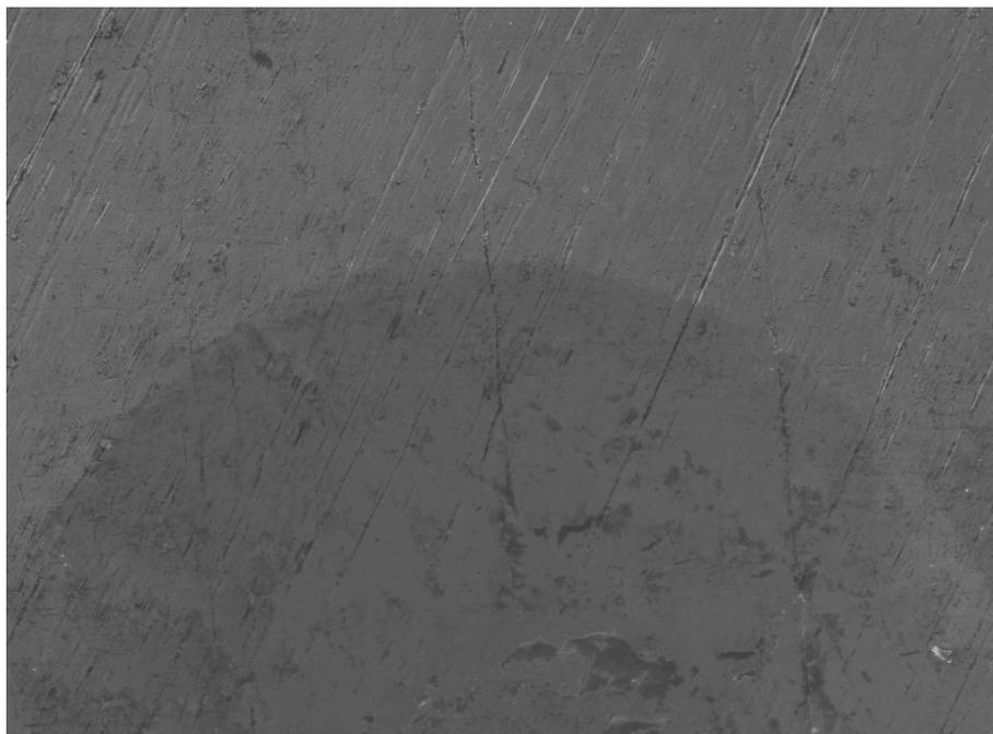
Abbildung 11.22: Darstellung des Eindrucks der Probe 5 im REM mit SE-Detektor, 10000 Zyklen
