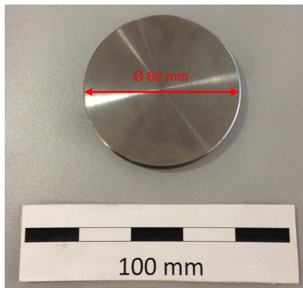
Abbildung 4.1: Darstellung der Probescheiben für den Impact- und Scratchtest
