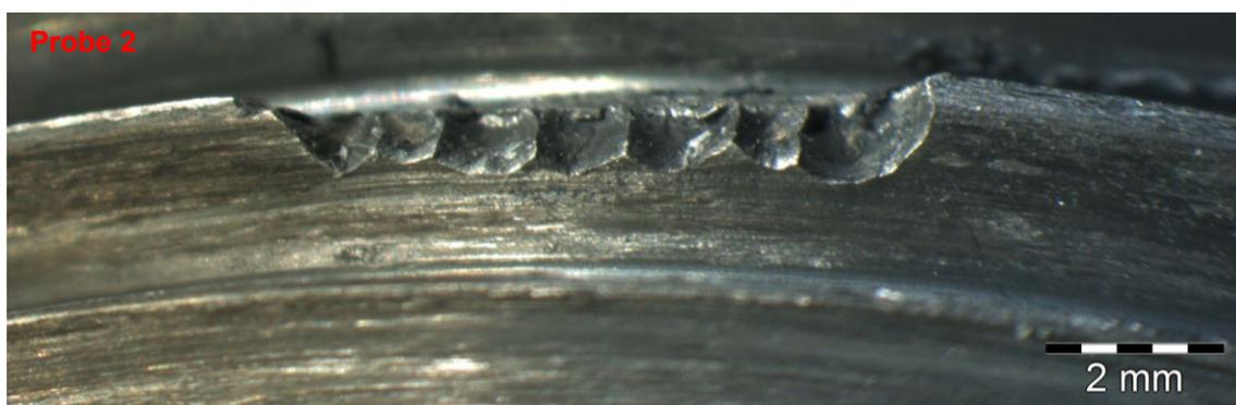
Abbildung 5.33: Darstellung des Gewindespitzenabbruches infolge der hohen Beanspruchung nach 150 Anzügen
