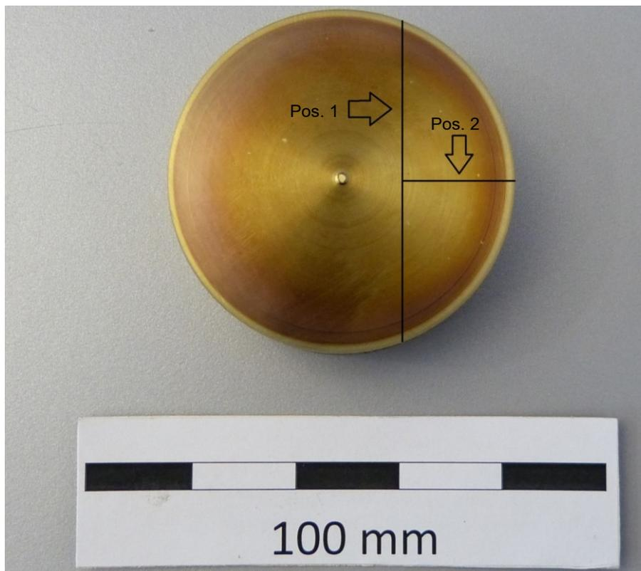
Abbildung 11.1: Darstellung der Probescheibe (plasmanitriert) mit den Positionen für die Mikrohärteprüfung
