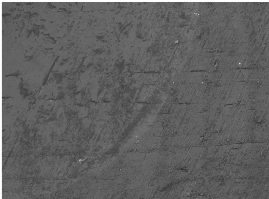
Abbildung 11.20: Darstellung des Eindrucks der Probe 5 im REM mit SE-Detektor, 1000 Zyklen
