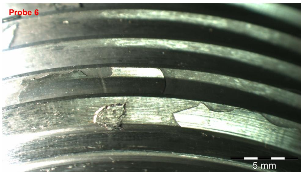
Abbildung 5.25: Übersicht der Gewindegänge von Probe 6 bei 15 Anzügen mit einem Schlagschrauber
