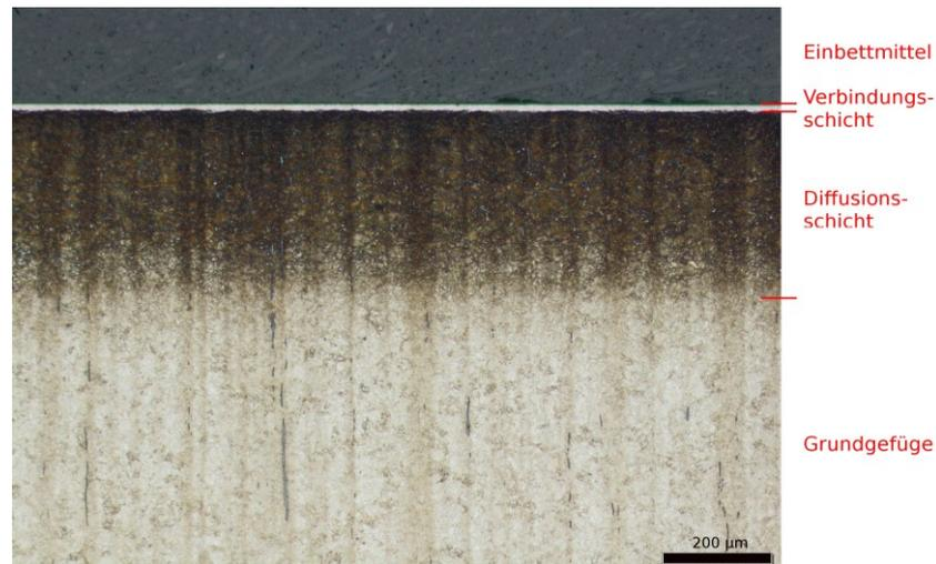
Abbildung 3.3: Aufbau einer Nitrierschicht bei einer Titanlegierung<sup>[15]</sup>
