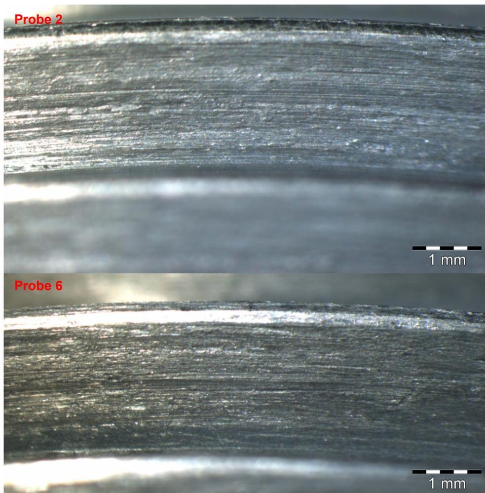
Abbildung 5.31: Darstellung des Verschleißes an den Gewindeflanken bei 90 Anzügen mit einem Schlagschrauber, Probe 2 und Probe 6
