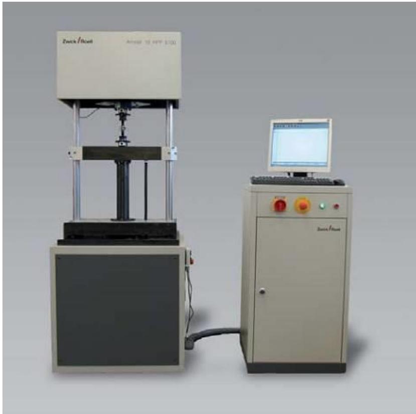
Abbildung 4.2: Hochfrequenzpulsator Amsler HFP 5100 der Fa. Zwick <sup>[16]</sup>
