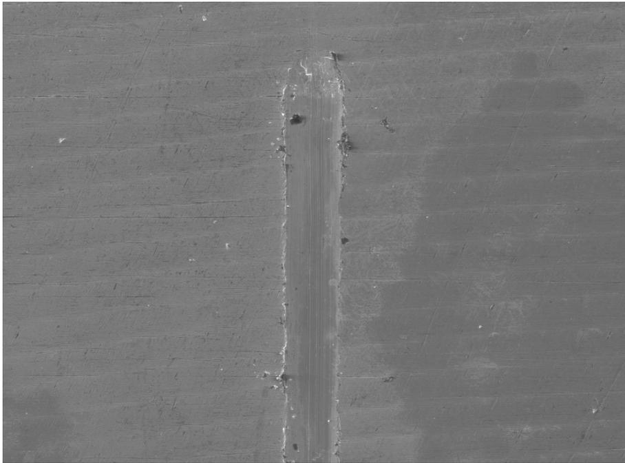
Abbildung 5.18: Darstellung des Defekts der Probe 5 im REM mit 150-facher Vergrößerung
