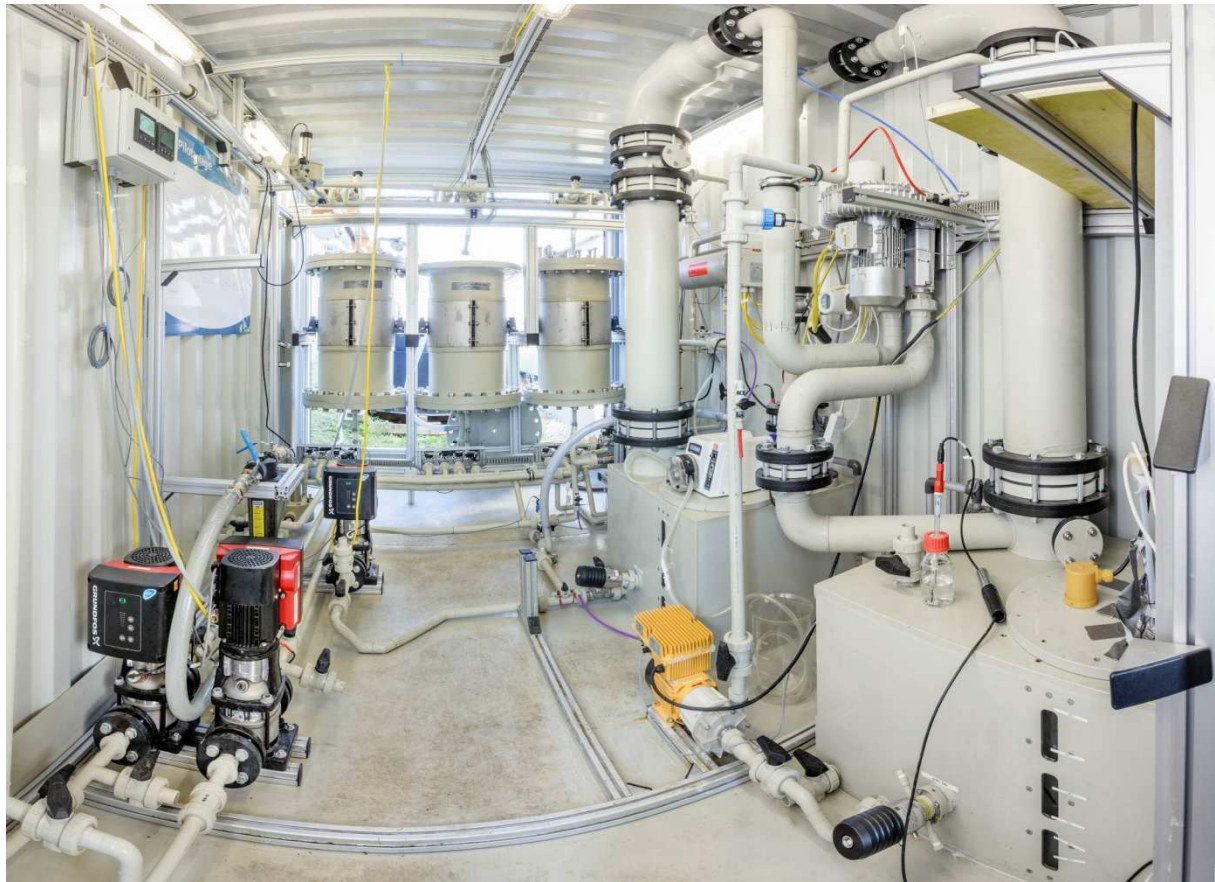
Abbildung 20: Aufbau der Containerversuche während der Zielversuche: von links nach rechts: P2 mit Filter, P3, P4, drei Festbettreaktoren, Stripper und Wäscher. © Christof Industries
