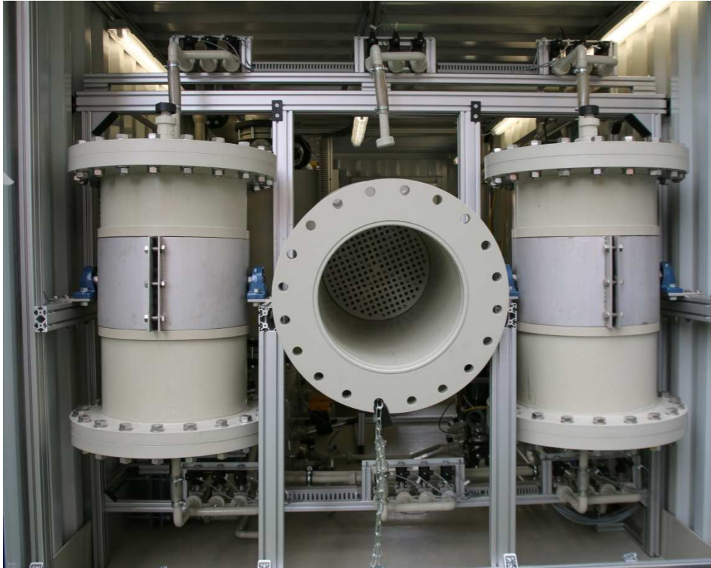
Abbildung 21: drehbar gelagerte Reaktoren, zur erleichterten Entleerung der Zeolithschüttung
