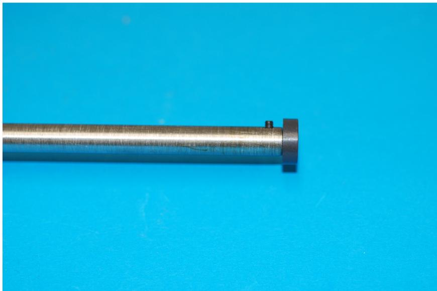
Abbildung 11: Der Probenstempel aus  $\text{Si}_3\text{N}_4$
