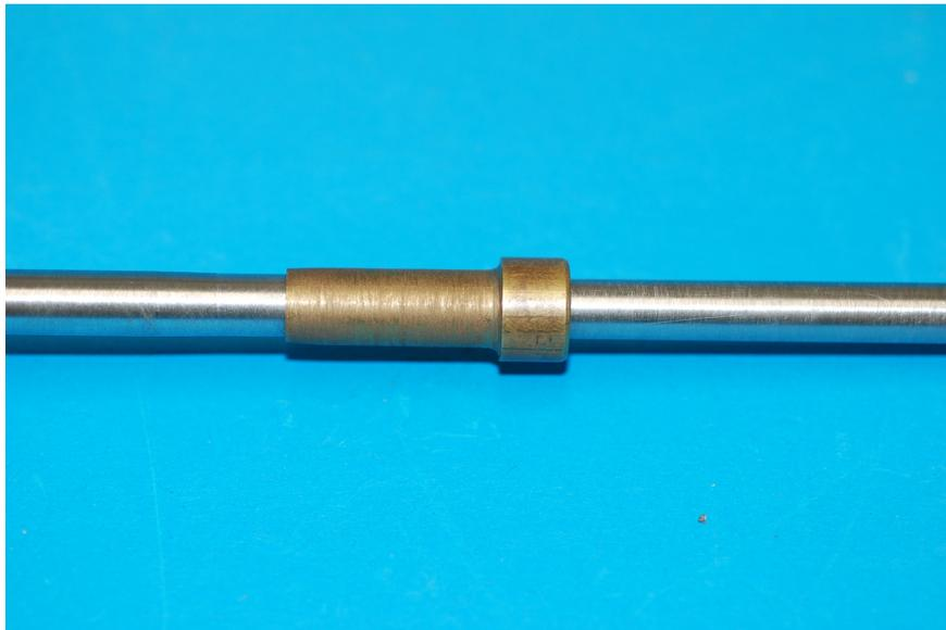
Abbildung 12: Stahlhülse zur Positionierung des Ofens in Relation zum Stempel
