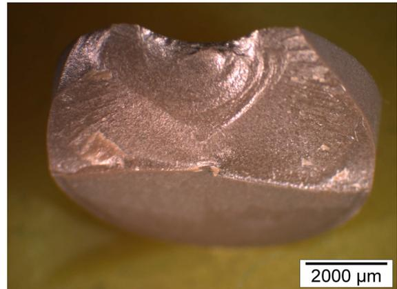
Abbildung 13.1: Ungültiger Versuch an einem originalen PTC-Bauteil (Höhe ca. 2,26 mm) bei 200 °C. Das Dickenverhältnis der Probe ist zu groß (0,6) und der Bruch geht nicht von der Probenmitte, sondern von einer Kontaktstelle mit einer Kugel aus.
