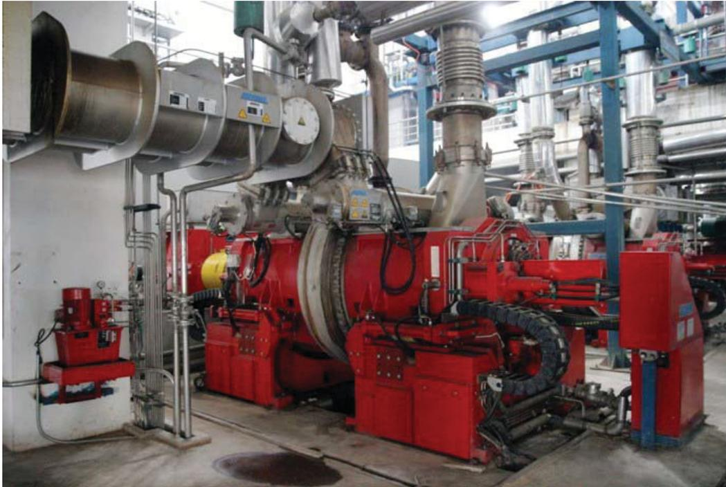
Abbildung 2.1: Mechanische Herstellung von Holzschliff mittels Refiner [6].
