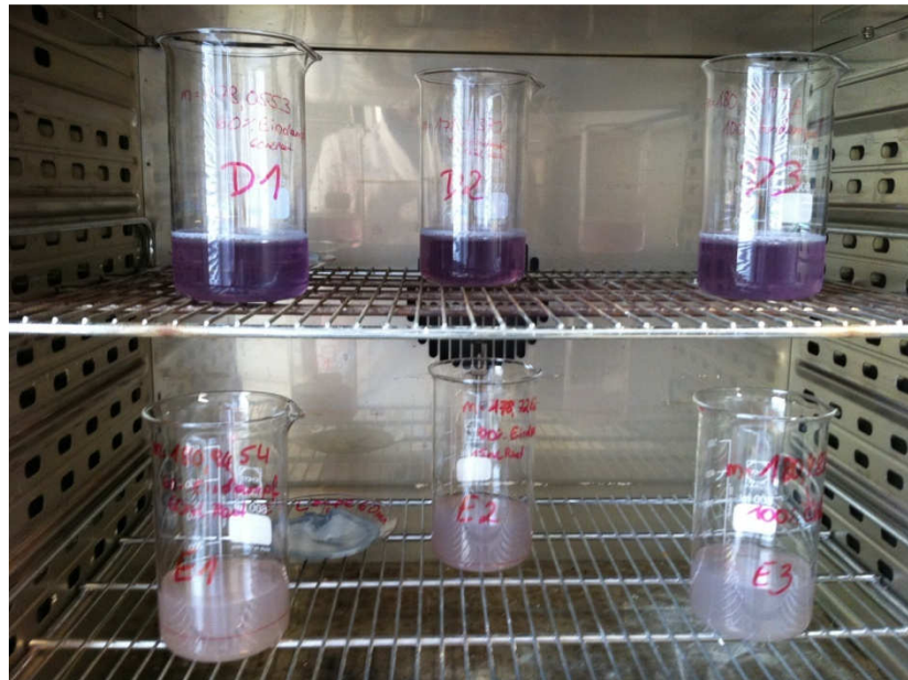
Abbildung 6.9: Kristallisationsaggregat (Binder Umlufttrockenschrank) mit 600 ml Schott-Duran Bechergläser
