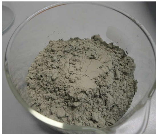
Abbildung 6.4: Hartmetallweichschrott (nach Vorbehandlung, saurer Bindemetalllaugung und oxidierender Röstung)
