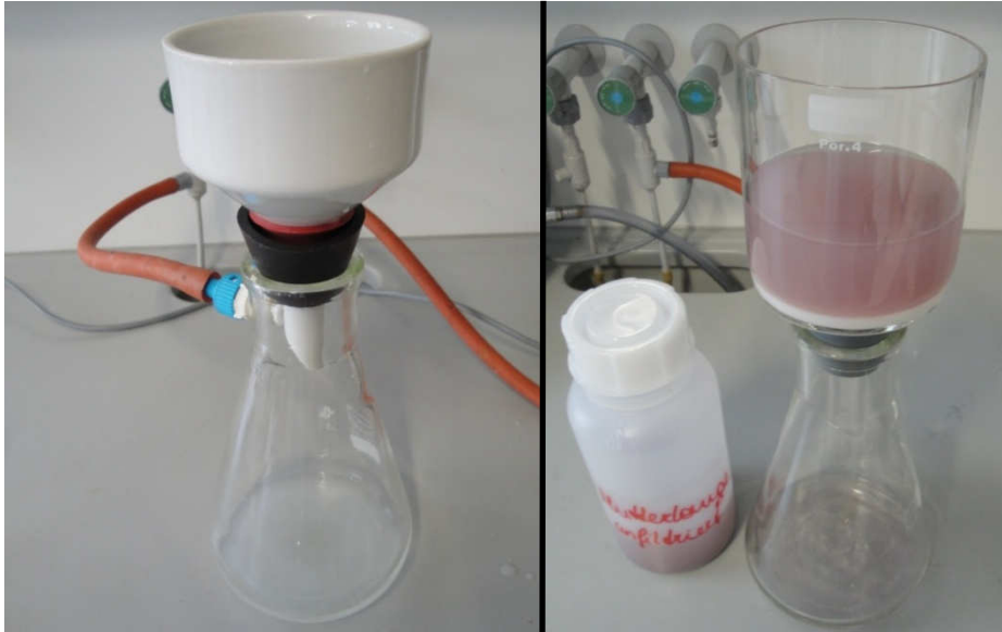
Abbildung 6.6: Versuchsaufbau der Filtration mit Papierfilter (links) und Keramikfilter (rechts)
