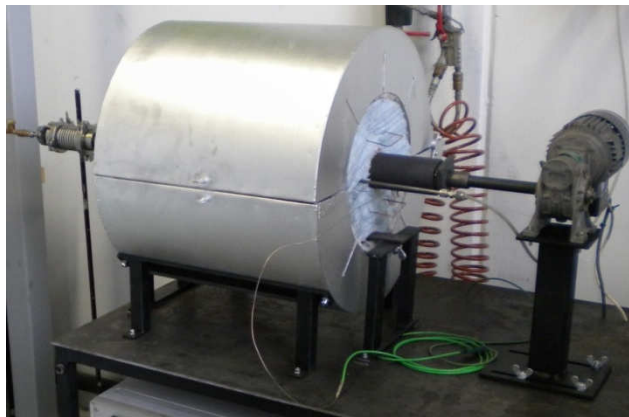
Abbildung 6.2: Verwendeter Drehtrommelofen für den Pyrolyseschritt [25]
