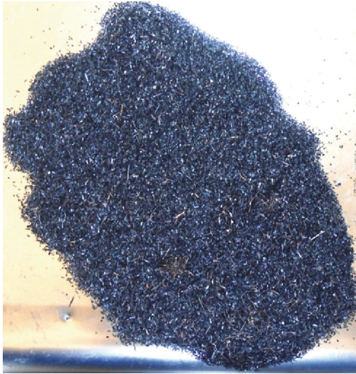
Abbildung 5-29: Darstellung der Fraktionsanteile 0,5–1 mm
