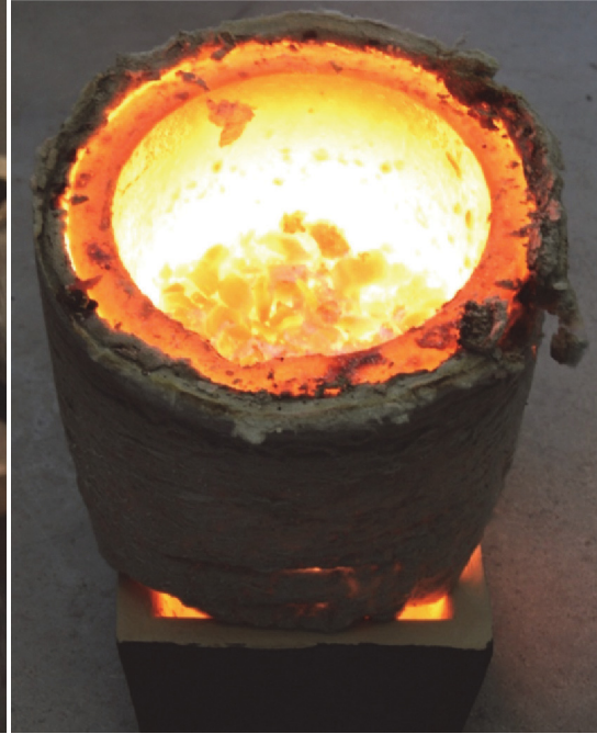
Abbildung 4-25: Auskühlen des Tiegels an Luft
