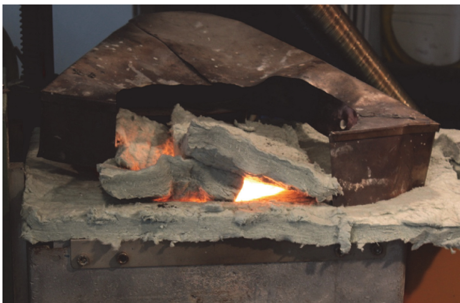
Abbildung 4-14: Induktionstiegelofen im Betrieb
