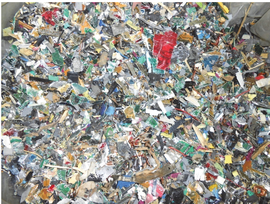
Abbildung 4-1: Leiterplattenschrott, welcher zu den Pyrolyseversuchen herangezogen wurde
