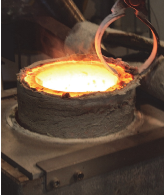
Abbildung 4-24: Entnahme des Tiegels aus dem Ofen
