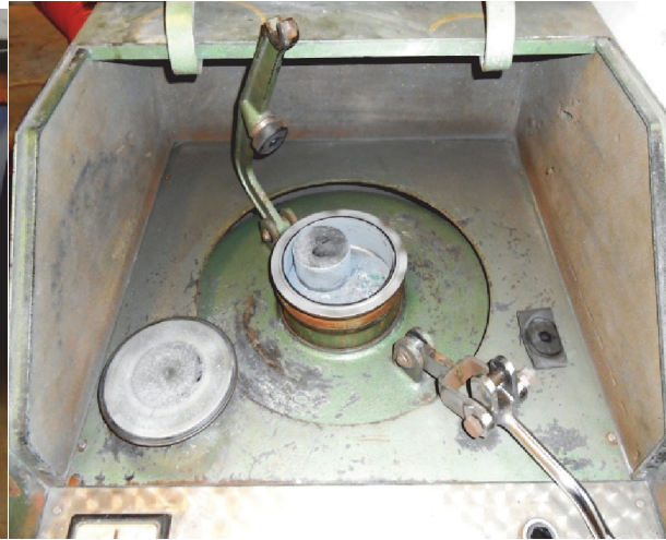
Abbildung 4-5: Gemahlener PCB-Schrott in der Schwingmühle (Siebtechnik Scheibenschwingmühle-TS)
