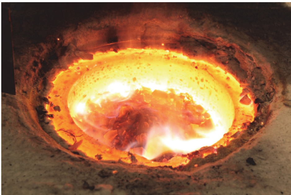
Abbildung 4-23: Tiegel mit bereits größtenteils aufgeschmolzenem Schrott
