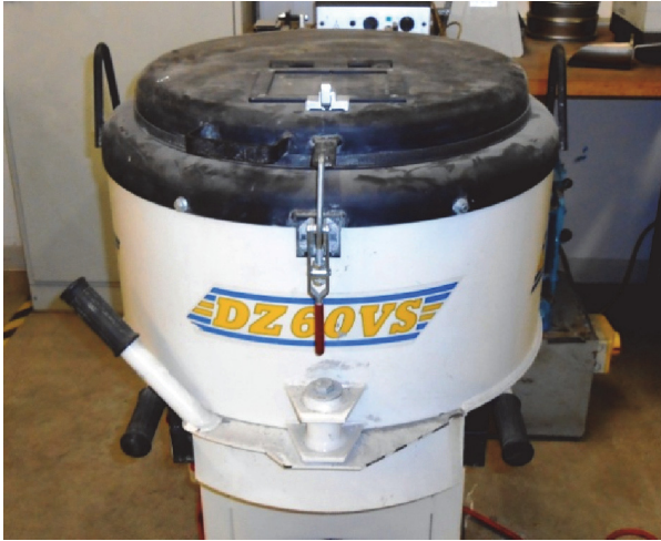
Abbildung 4-4: Aufbau des Mixers (Mischer Diem DZ60VS)
