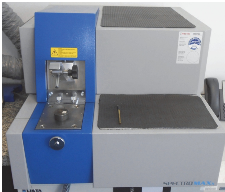
Abbildung 4-29: Funkenspektrometer (SPECTRO MAXx) zur Ermittlung der Elementgehalte
