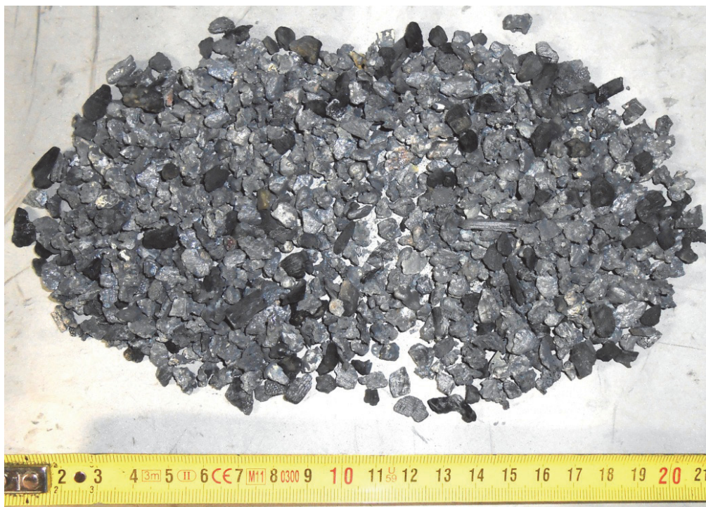
Abbildung 5-42: Darstellung der Schlackenfraktionsanteile 4–6,3 mm
