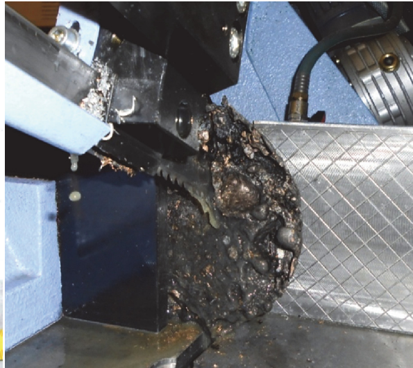
Abbildung 4-28: Zerschneiden des Metallstücks für weitere Analysen
