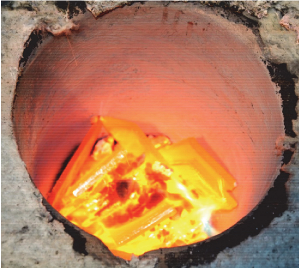
Abbildung 4-15: Tiegel mit sich erwärmenden Kupferstücken
