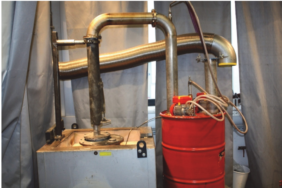
Abbildung 4-8: Prinzipieller Aufbau der Pyrolyseanlage
