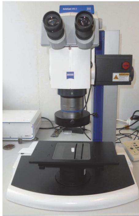
Abbildung 4-2: Stereomikroskop (Zeiss SterEO Discovery V12) zur Vorcharakterisierung von Leiterplattenschrott
