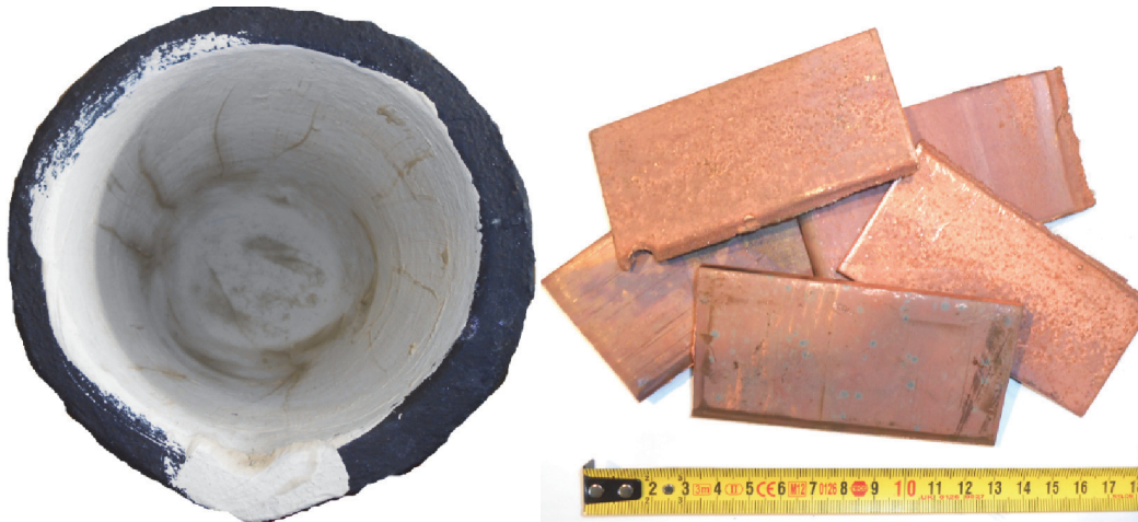
Abbildung 4-12: Geschichteter Tiegel Abbildung 4-13: Kupferstücke als Sammelmetall
