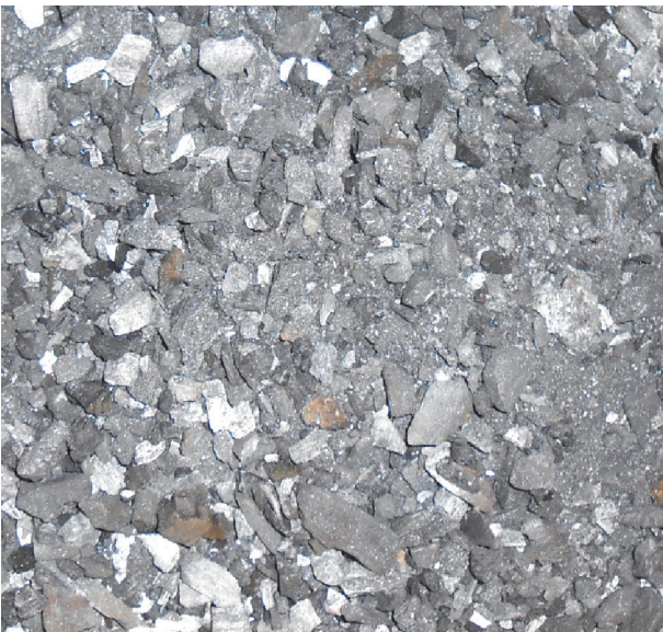
Abbildung 4-17: Zerkleinerte Holzkohle als Reduktionsmittel
