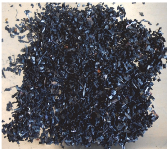
Abbildung 5-27: Darstellung der Fraktionsanteile 2\text{--}4 \text{ mm}
