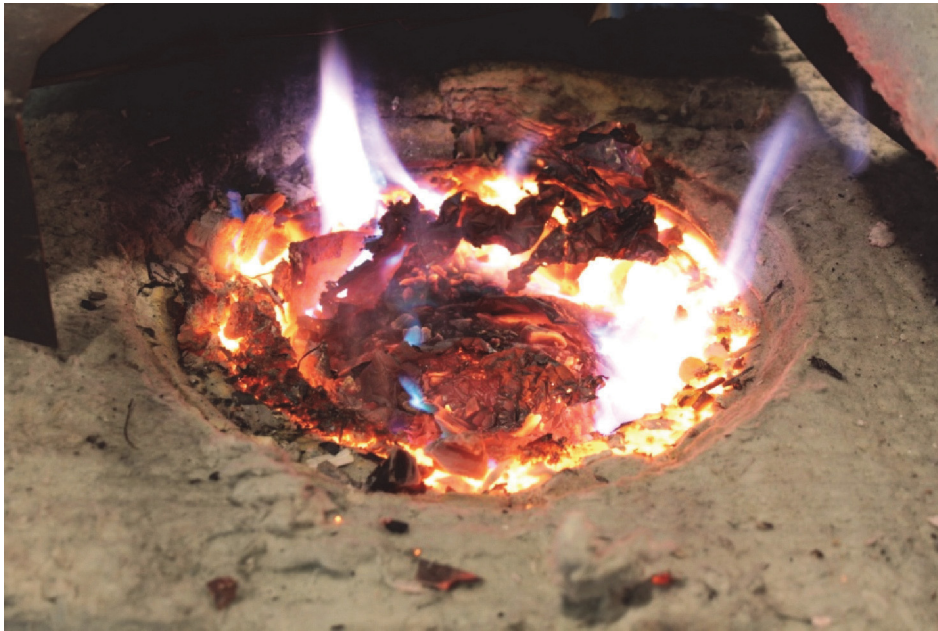
Abbildung 4-22: Tiegel mit frisch chargiertem Schrott
