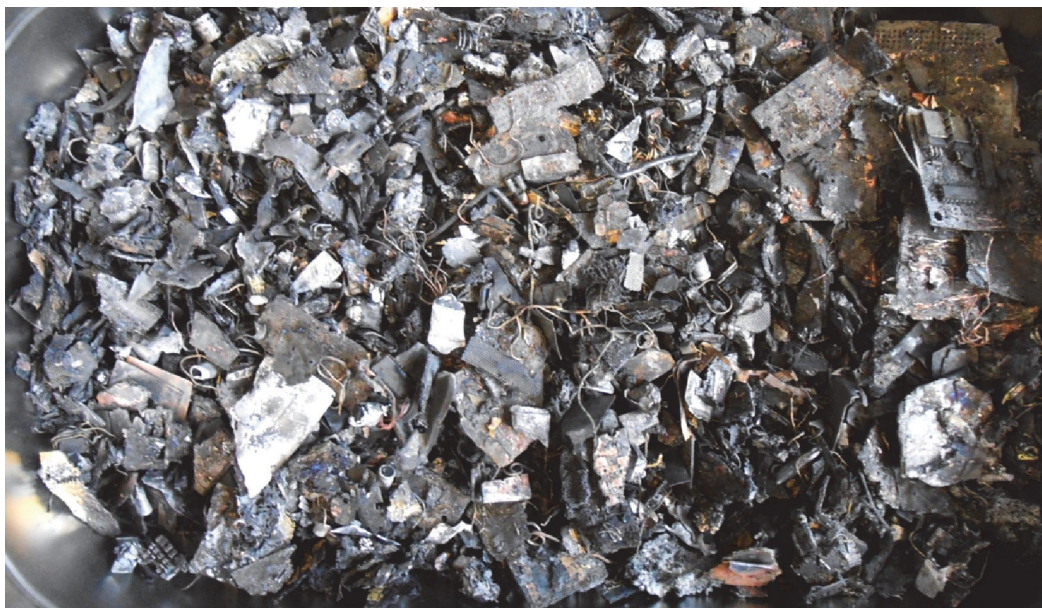
Abbildung 5-7: Pyrolyserückstand bei T = 600\text{ °C} und t = 240\text{ min}
