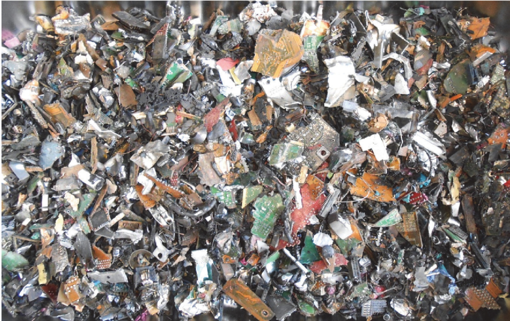
Abbildung 5-6: Pyrolyserückstand bei T = 250\text{ °C} und t = 30\text{ min}
