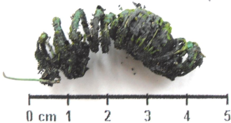
Abbildung 5-17: Leiterplattenschrott nach der Pyrolyse V
