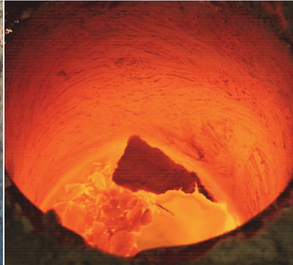
Abbildung 4-16: Bereits flüssiges Kupfer im Tiegel
