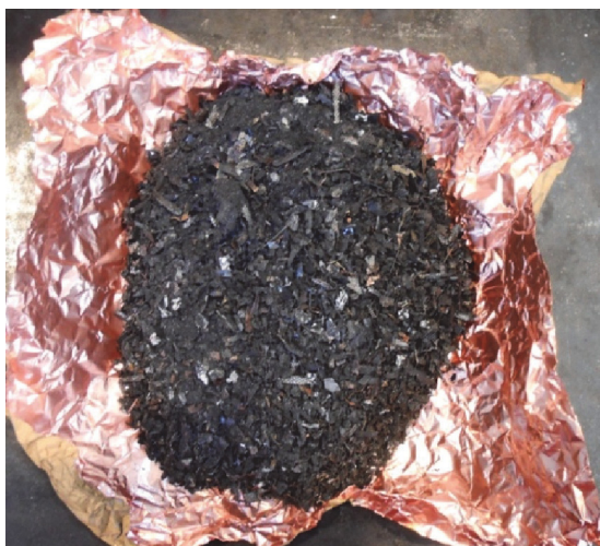
Abbildung 4-20: Feinfraktion des Pyrolyserückstands in Kupferfolie I
