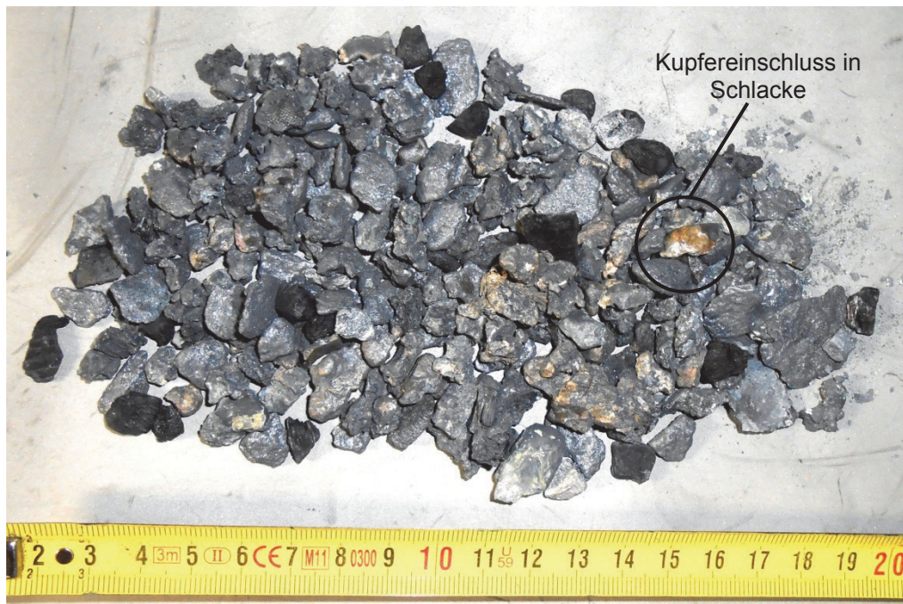
Abbildung 5-41: Darstellung der Schlackenfraktionsanteile > 6,3 mm
