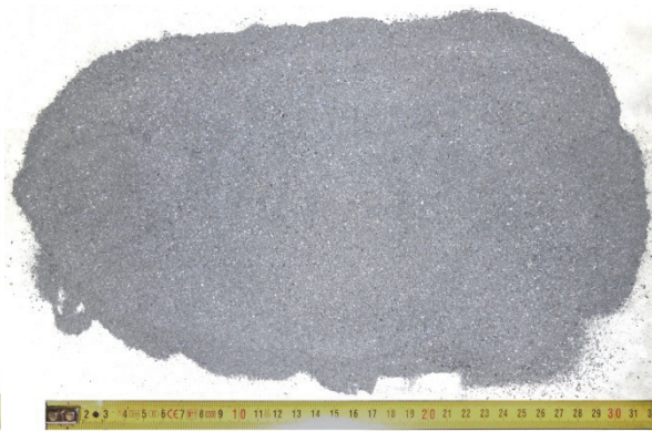
Abbildung 5-44: Darstellung der Schlackenfraktionsanteile < 1 mm
