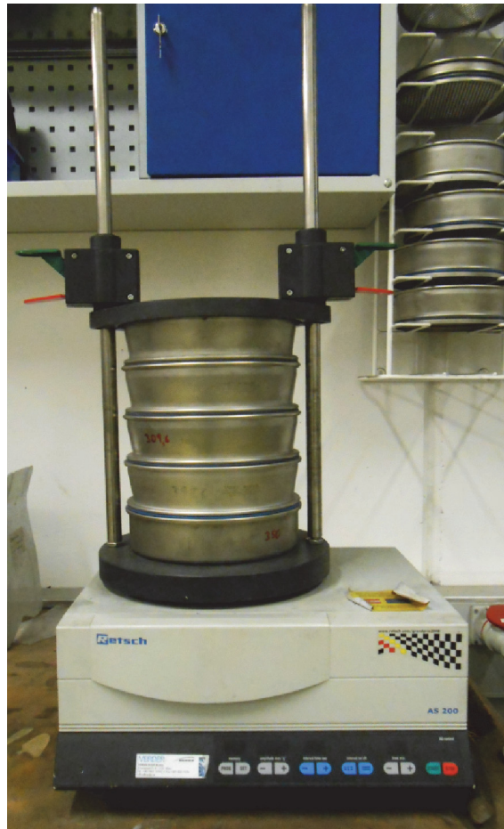
Abbildung 4-11: Aufbau der Siebvorrichtung
