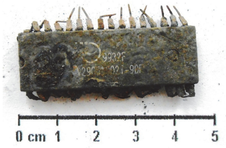
Abbildung 5-21: Leiterplattenschrott nach der Pyrolyse VII
