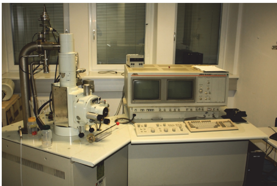
Abbildung 4-3: Aufbau des Rasterelektronenmikroskops (Typ JSM 6400)
