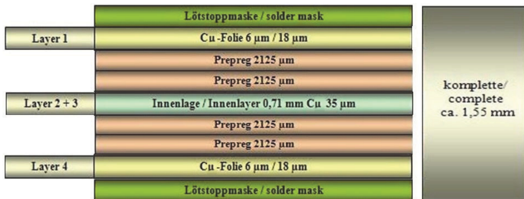
Abbildung 3-19: Schematischer Schichtenaufbau einer Mehrschicht-Leiterplatte [27]
