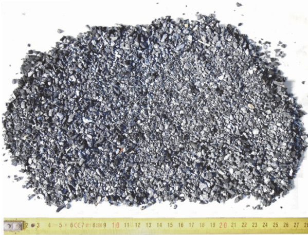
Abbildung 5-43: Darstellung der Schlackenfraktionsanteile 1–4 mm
