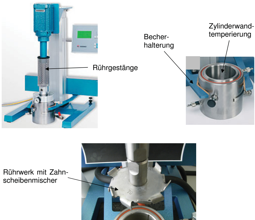
Abb. 3.3: Wesentliche Bauteile des Vakuum-Dispergiersystem CDS der Firma VMA Getzmann GmbH Verfahrenstechnik (Reichshof, D).
