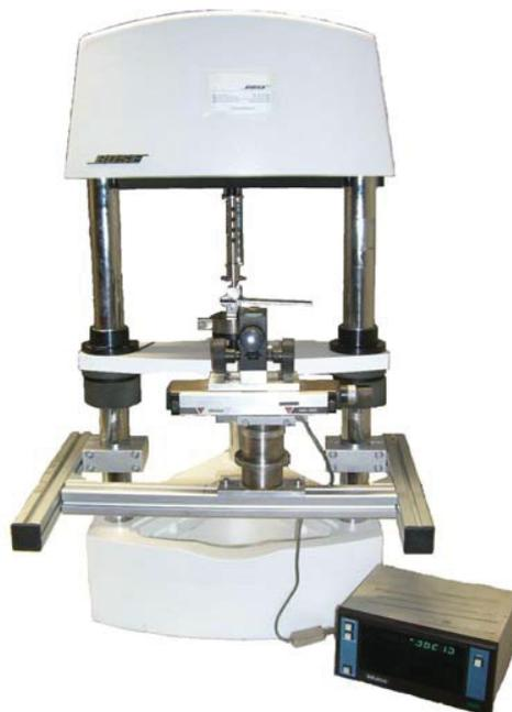
**Abb. 3.12:** Elektrodynamische Prüfmaschine „Bose Elektroforce 3200“.
