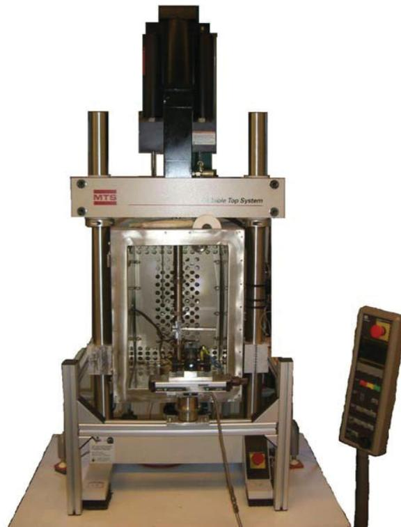
**Abb. 3.10:** Servohydraulische Prüfmaschine „MTS 858 Table Top System“.
