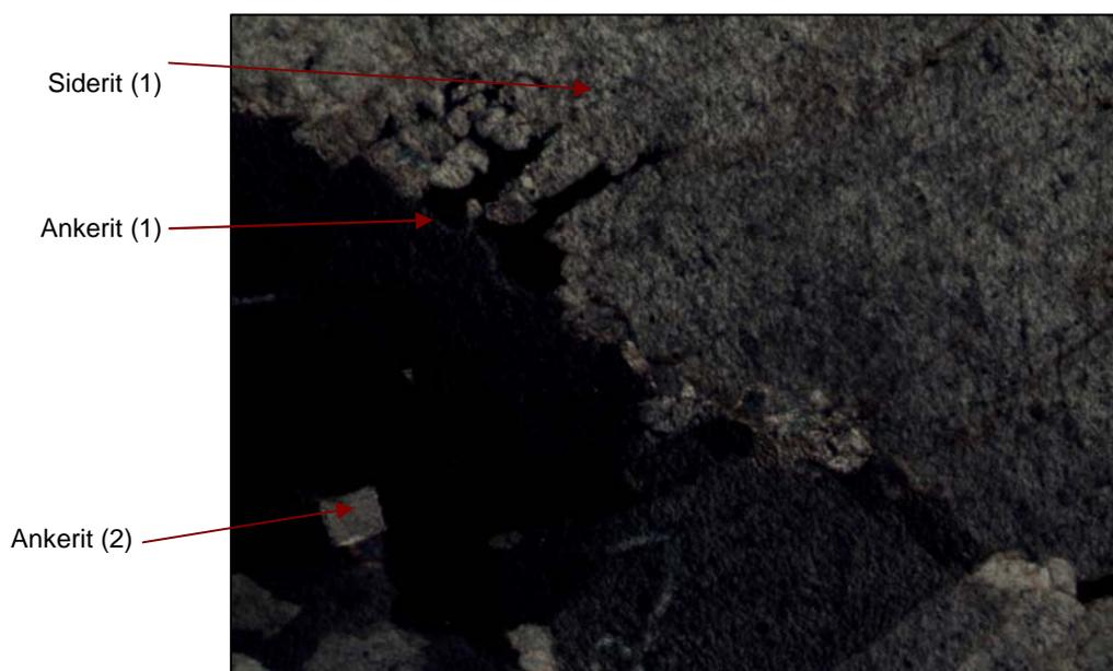
Abb. 69: Dünnschliff WEGS2a: Verdrängung des Siderits (1) durch Ankerit (1) (+N, Bildbreite: 2,67mm).
