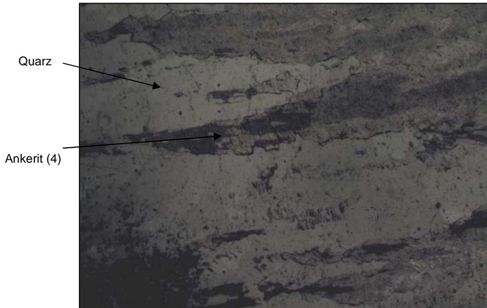
Abb. 80: Dünnschliff VORA10a: Kluft innerhalb einer Erzbrekzienkomponente mit Faserquarz und fasrigem Ankerit (4) (+N, Bildbreite: 2,67mm).
