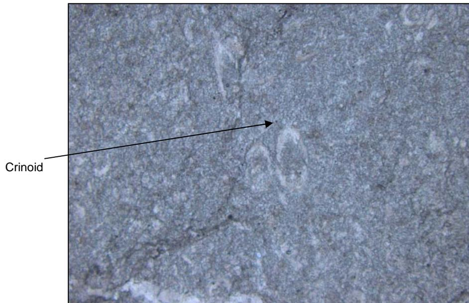
Abb. 14: Dünnschliff LIED1: Bioklasten im Bereich des Sauberger Kalkes (+N, Bildbreite: 1,77 mm).
