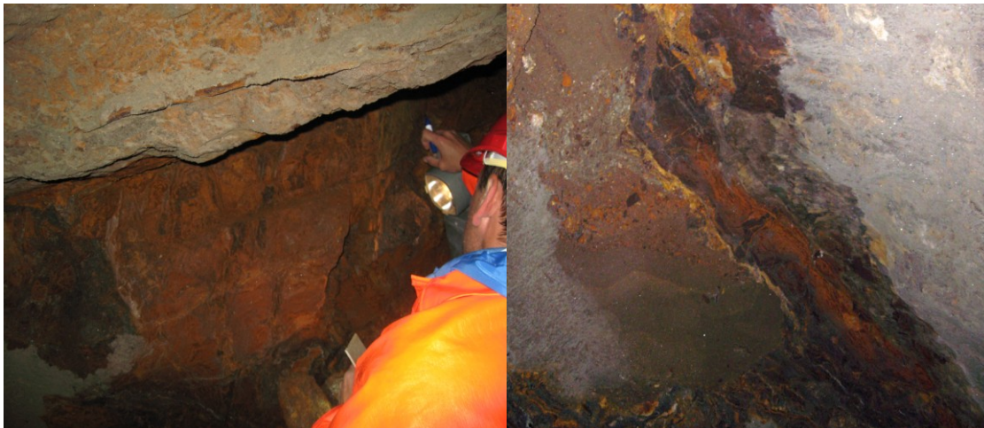
Abb. 18: links: Beprobung KE5; rechts: verschlammtes Erz (Hoffnungsstollen)
