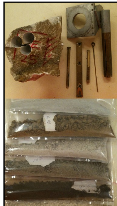
Abb. 13: Probenahme und Aufbereitung; Oben: Handstück KE25 mit Kernbohrungen normal auf die Orientierungsfläche und Entnahmewerkzeug; Unten: Pulverpräparate für die Curiepunkts-Bestimmung und die AAS-Analytik
