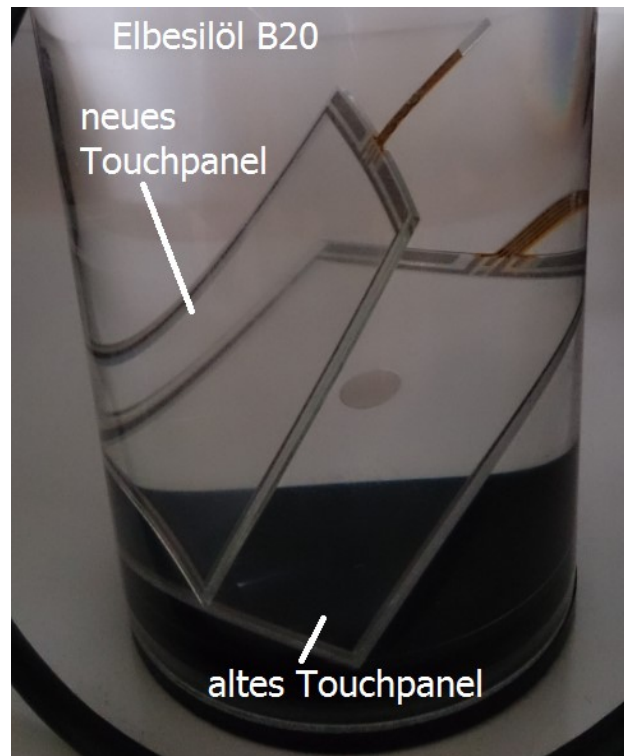
Abbildung 35: Befüllung mit Silikonöl Elbesil B20; Vergleich altes und neues Touchpanel
