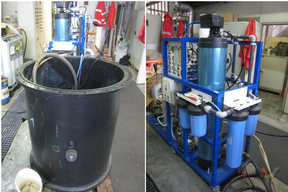
Abbildung 7: Vorlagebehälter, Sandfilter, Feinfilter und Aktivkohlefilter der Pilotanlage. Die Umkehrosmoseeinheiten befinden sich auf der Rückseite der Anlage und sind hier nicht ersichtlich. Die Abbildungen 49 und 51 der Laboranlage zeigen ein verwendetes Umkehrosmosemodul.
