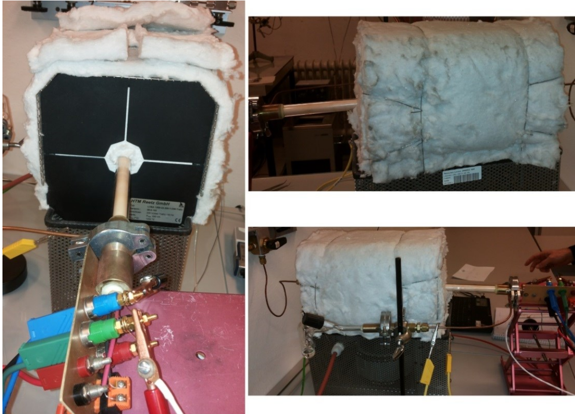
Abbildung 19: Ofen mit installiertem Quarzreaktor.
