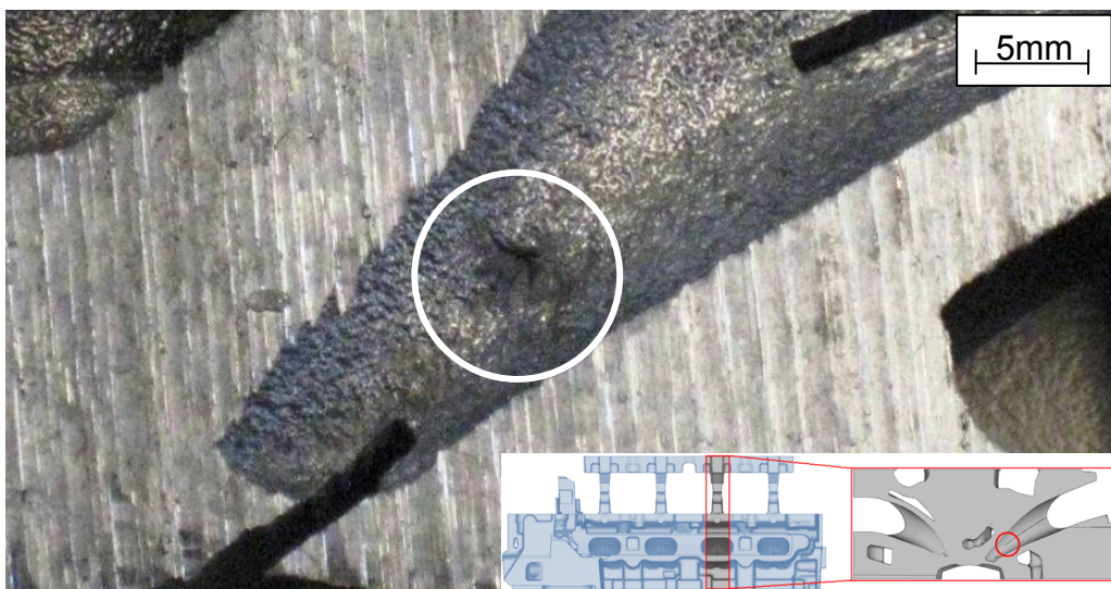
Abbildung 48: Ungebrochene trichterförmige N20 Fehlstelle
