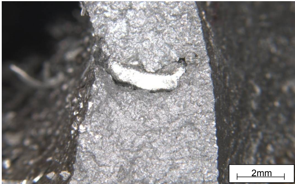
Abbildung 51: Bruchfläche Fehlerart 3 Bild 1 ZK N63
