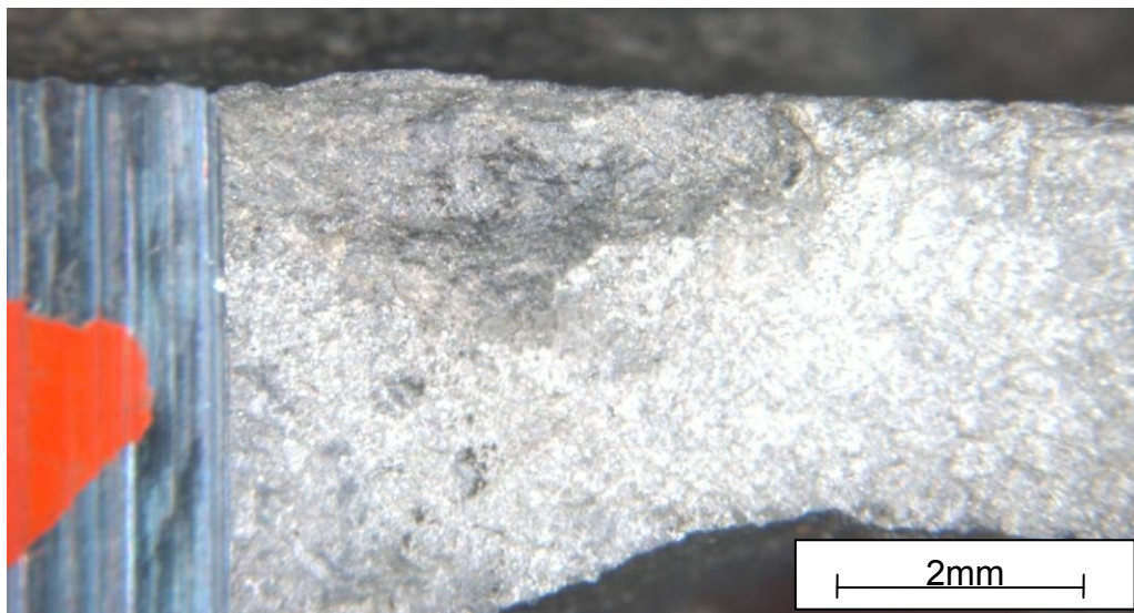
Abbildung 46: Bruchfläche Fehlerart 2 helle Variante ZK N63
