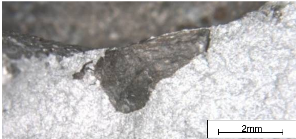
Abbildung 45: Bruchfläche Fehlerart 2 dunkle Variante ZK N63
