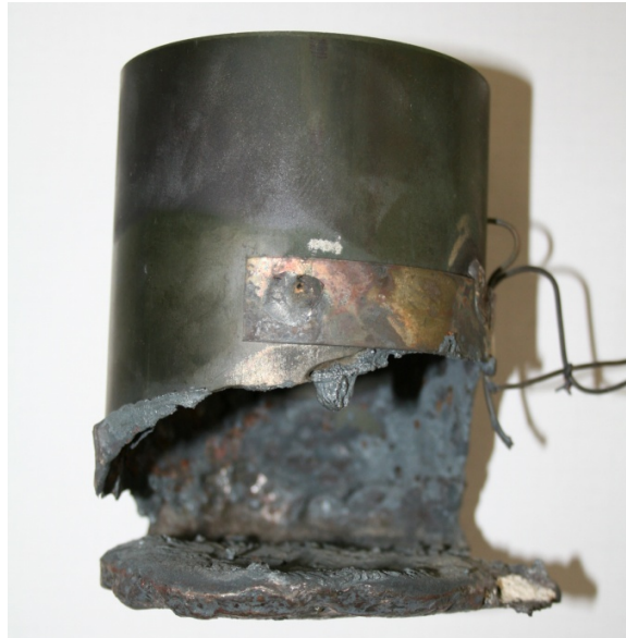
Abbildung 6-25: Verbundgussrohr der Materialpaarung Alloy 602CA/X11CrMoWVNb9-1-1 (2. Gießversuch, Rohr 2)
