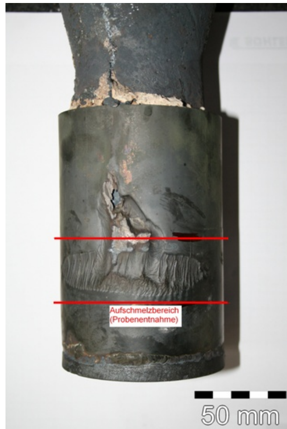
Abbildung 6-15: Verbundgussrohr der Materialpaarung Alloy 602CA/X11CrMoWVNb9-1-1 aus Gießversuch 1
