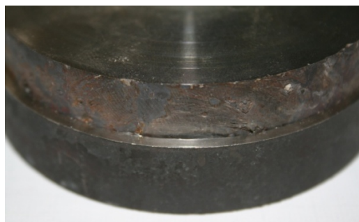
Abbildung 6-13: Makroskopische Betrachtung der Gießmetalloberfläche (X11CrMoWVNb9-1-1)
