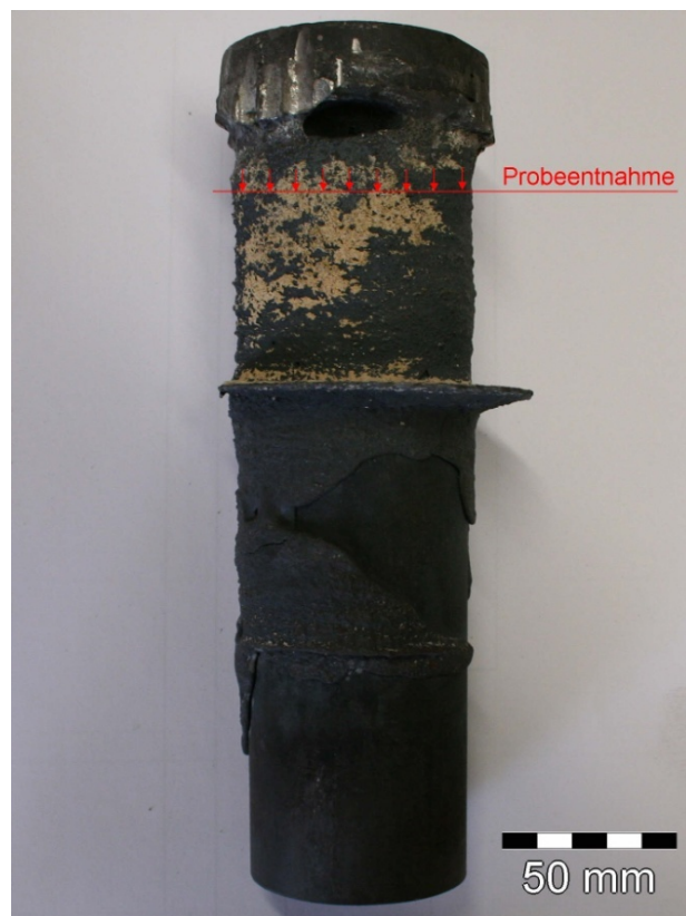
Abbildung 6-4: Verbundgussrohr der Materialpaarung 34CrAlMo5/34CrMo4
