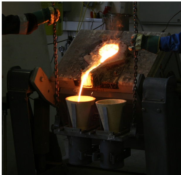
Abbildung 5-7: Gießvorgang für die Werkstoffkombination Alloy 602CA/X5CrNiMo17-12-2 und X11CrMoWVNb9-1-1 (1. Gießversuch)
