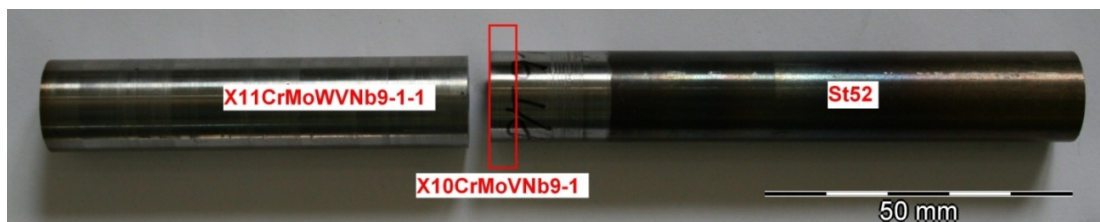
Abbildung 5-11: Reibschweißprobe für die Werkstoffkombination E911 und P/T91
