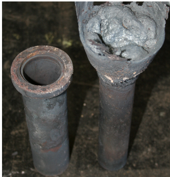
Abbildung 6-11: Werkstoffpaarung X10CrMoVNB9-1/X11CrMoWVNb9-1-1 nach dem Gießvorgang und erfolgter Abkühlung
