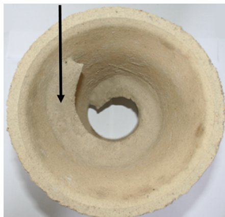
Abbildung 5-6: Modifizierter Gießtrichter mit Gießspirale
