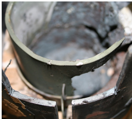
Abbildung 6-24: Verbundgussrohr der Materialpaarung Alloy 602CA/X11CrMoWVNb9-1-1 (2. Gießversuch, Rohr 1)
