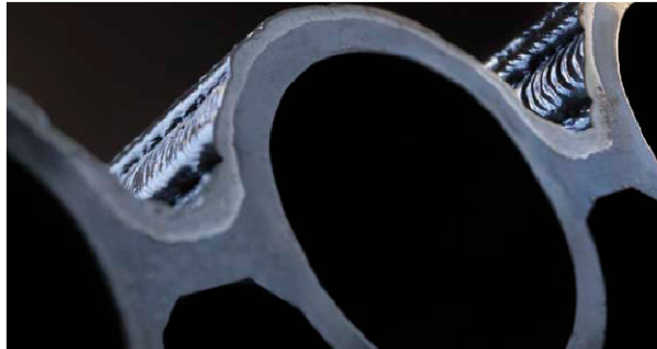
Abbildung 4-6: Darstellung einer Schweißplattierung [20]
