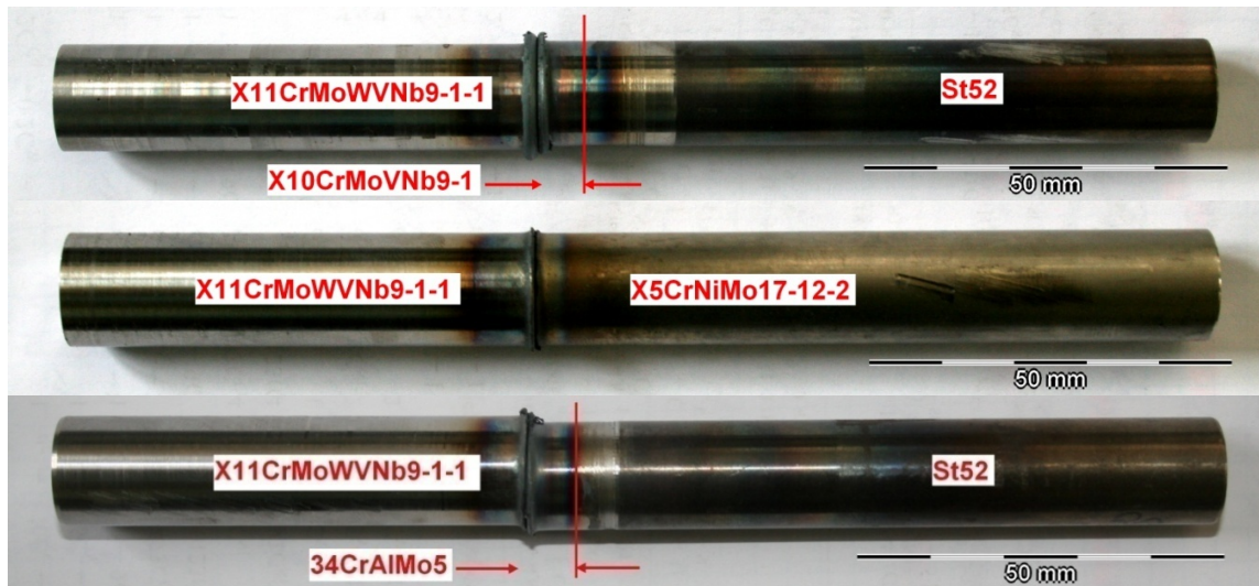
Abbildung 12-5: Makroskopische Gegenüberstellung der Reibschweißergebnisse für die Materialpaarungen X10CrMoVNb9-1, X5CrNiMo17-12-2, 34CrAlMo5/X11CrMoWVNb9-1-1
