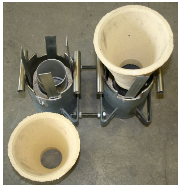
Abbildung 5-4: Aufbau der Gießkonsole für die Rohrwerkstoffe Alloy 602CA und X5CrNiMo17-12-2
