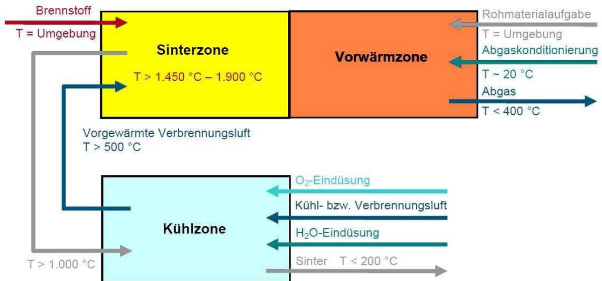
**Abbildung 5:** Schema Langdrehrohr [10, S.121]
