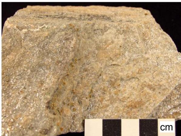
Abbildung 55: Probe 7B, feinkörniges deutlich geschiefertes helles Gestein mit seidig glänzenden Muscovitblättchen auf den Hauptbruchflächen, Aufschlussnr. 14, Kareck Nordostgrad
