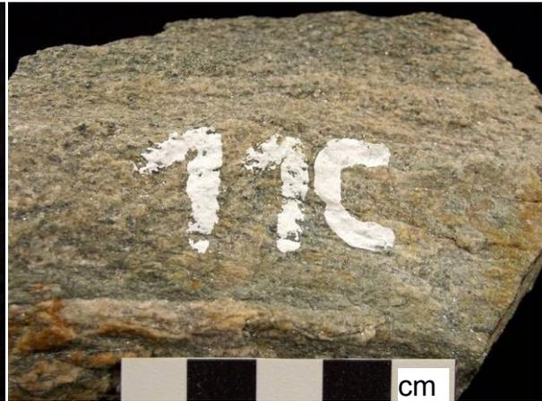
Abbildung 48: Probe 11C, sehr albitreiches Gestein mit typischen ockerfarbenen Verwitterungsbilägen Aufschlussnr. 22, ober Sternhütte
