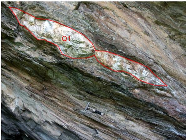
Abbildung 30: Boudinierte Q1 Linse in Albit-Gneis unterhalb des Kalverienbergstollens, Nr. 23
