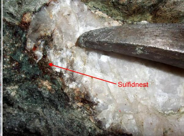
Abbildung 24: Sulfidnest am Kontakt zwischen Quarz und Nebengestein
