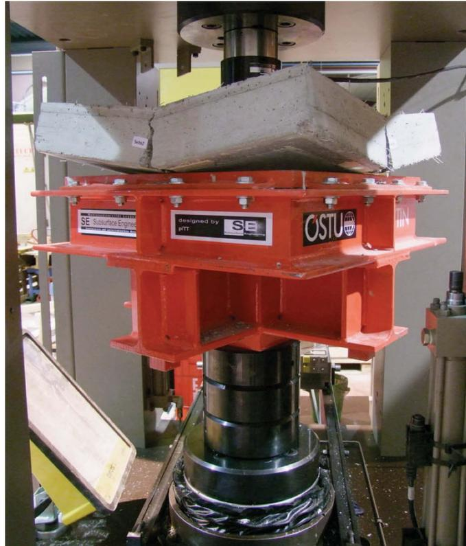
Abbildung 4.2: Prüfkörper und Trägerrost auf dem Hubkolben der Prüfmaschine aufgesetzt
