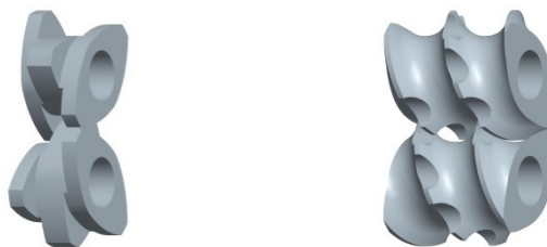
Abbildung 11: Knetelement KB 3-2-15-60GRD-RE (links) und Mischelement GFM 2-30-30 (rechts)
