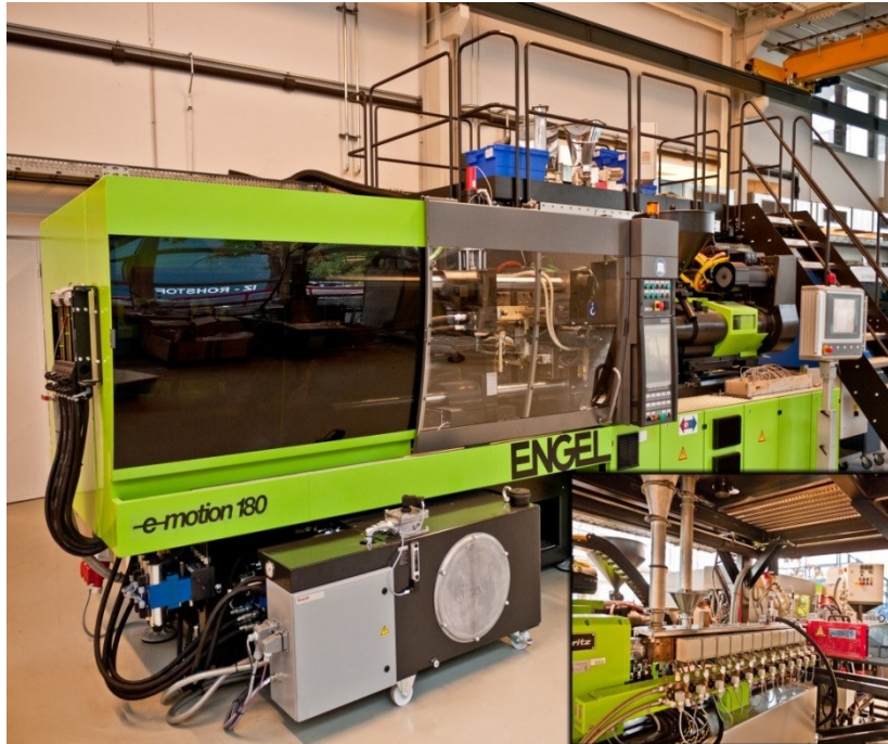
Abbildung 4: Spritzgießcompounder des Lehrstuhls für Spritzgießen von Kunststoffen an der Montanuniversität Leoben
