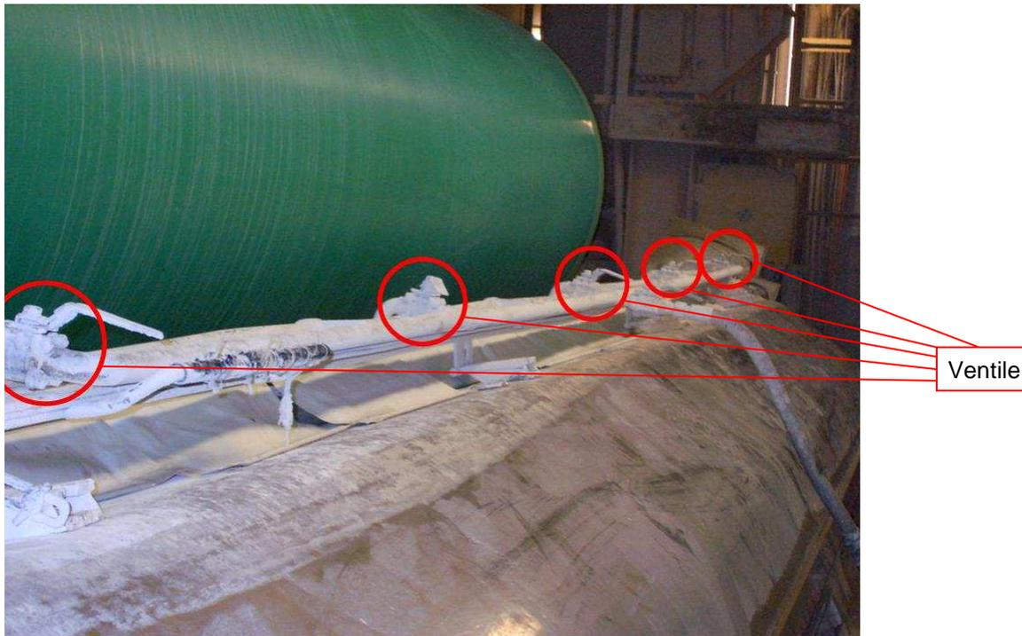
Abbildung 20: Ventile der Nebeldüsen über gesamte PM-Breite
