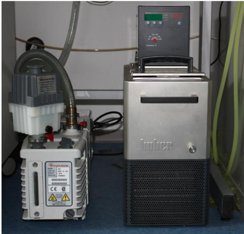
Abbildung 7-6: Ansicht der Vakuumpumpe (links) und des Umwälzthermostaten (rechts)
