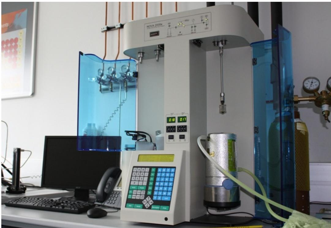
Abbildung 7-5: Oberflächen- und Porositätenmessgerät NOVA 2000e der Firma Quantachrome
