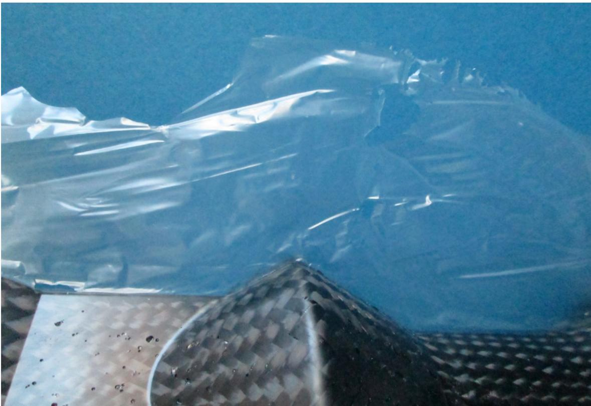
Abbildung 38: Bauteil mit entformtem Harzfilm als Zeichen der Trenngüte. Zur besseren Visualisierung wurde ein blauer Hintergrund gewählt.
