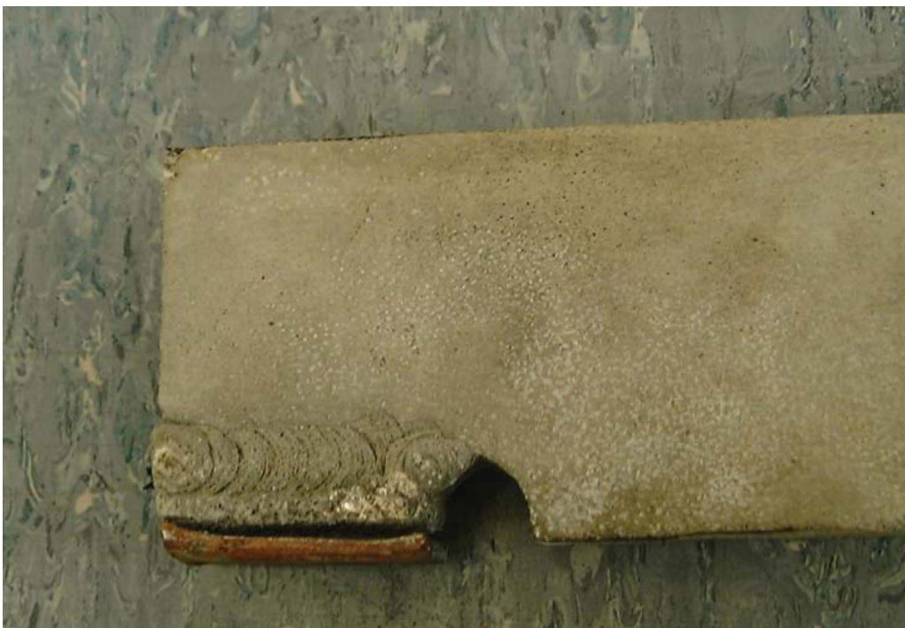
Abbildung 3.15: Angegriffener Cu-Kontakt (New Bolid Odda, Norzink)
