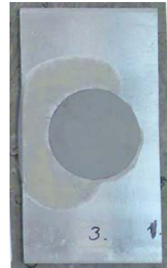
Abbildung 4.13: PP mit eingelegter coPE-Folie
