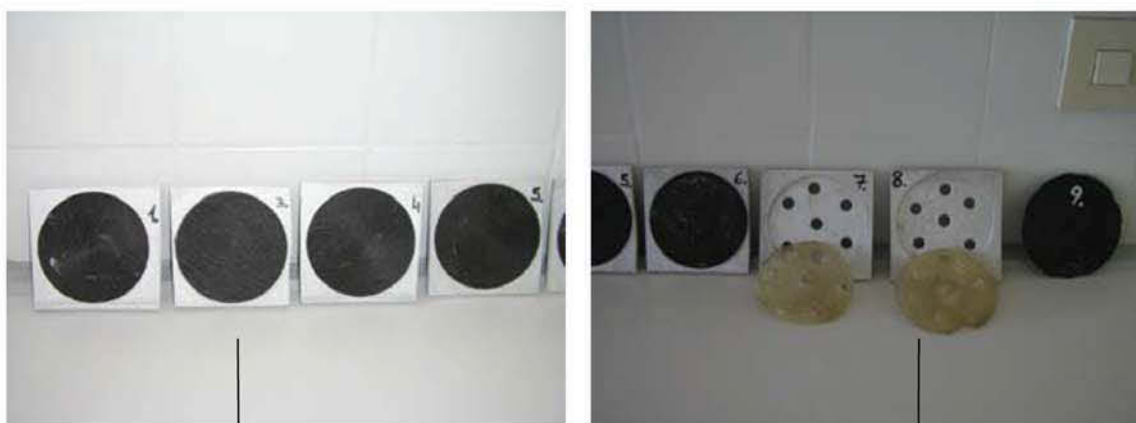
Abbildung 1 und 2 Kathodenblechdeckel nach Alterungstest
