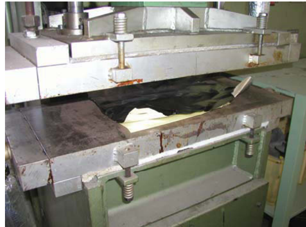
Abbildung 4.9: Heißpresse mit Aluminiumfolie für eine bessere Wärmeübertragung
