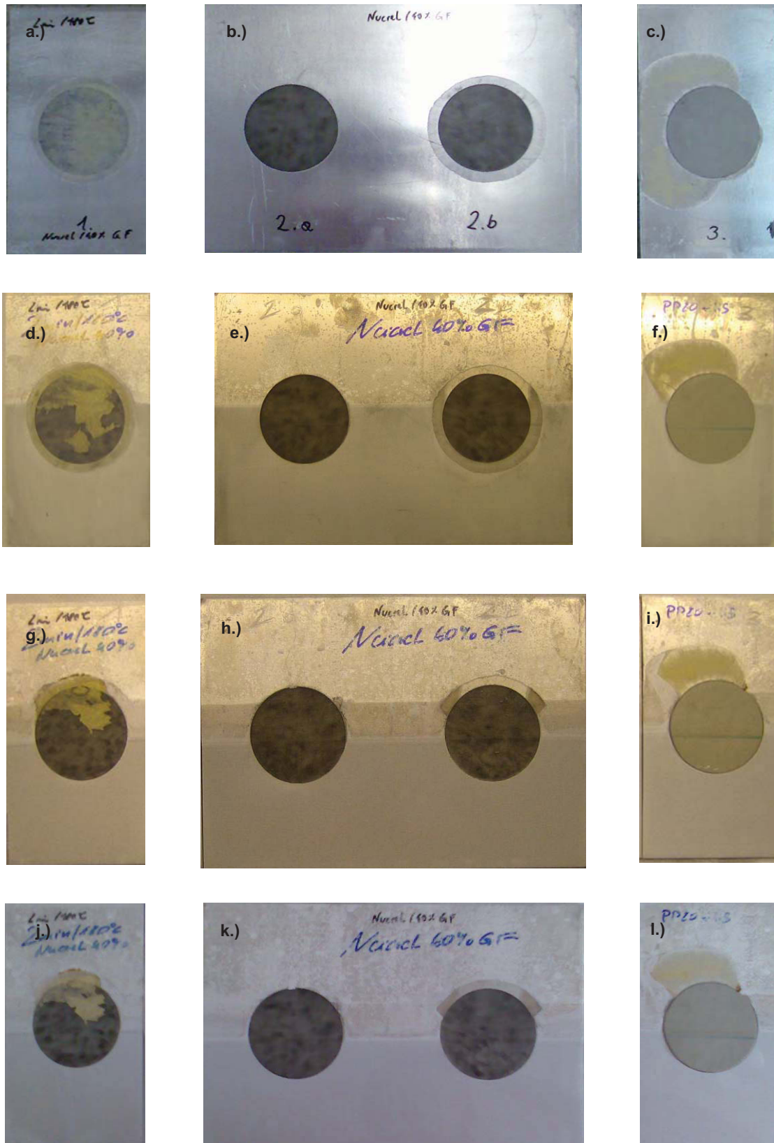
Abbildung 5.22: a.) GF-coPE-Einpressung bei konstanter Haltedauer (2·t); Versuchsstart, b.) GF-coPE-Einpressung bei konstanter Haltedauer (t); Versuchsstart, c.) PP-Einpressung bei konstanter Haltedauer (t); Versuchsstart, d.) GF-coPE-Einpressung bei konstanter Haltedauer (2·t); 1 Woche, e.) GF-coPE-Einpressung bei konstanter Haltedauer (t); 1 Woche, f.) PP-Einpressung bei konstanter Haltedauer (2·t); 1 Wochen, g.) GF-coPE-Einpressung bei konstanter Haltedauer (2·t); 2 Wochen, h.) GF-coPE-Einpressung bei konstanter Haltedauer (t); 2 Wochen, i.) PP-Einpressung bei konstanter Haltedauer (t); 2 Wochen, j.) GF-coPE-Einpressung bei konstanter Haltedauer (2·t); 3 Wochen, k.) GF-coPE-Einpressung bei konstanter Haltedauer (t); 3 Wochen l.) PP-Einpressung bei konstanter Haltedauer (t); 3 Wochen
