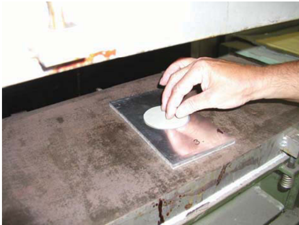
Abbildung 4.8: Einlegen der Disc in Heißpresse
