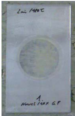
Abbildung 4.11: GF-coPE; Einpressung bei 180 °C und Haltedauer von 2 min
