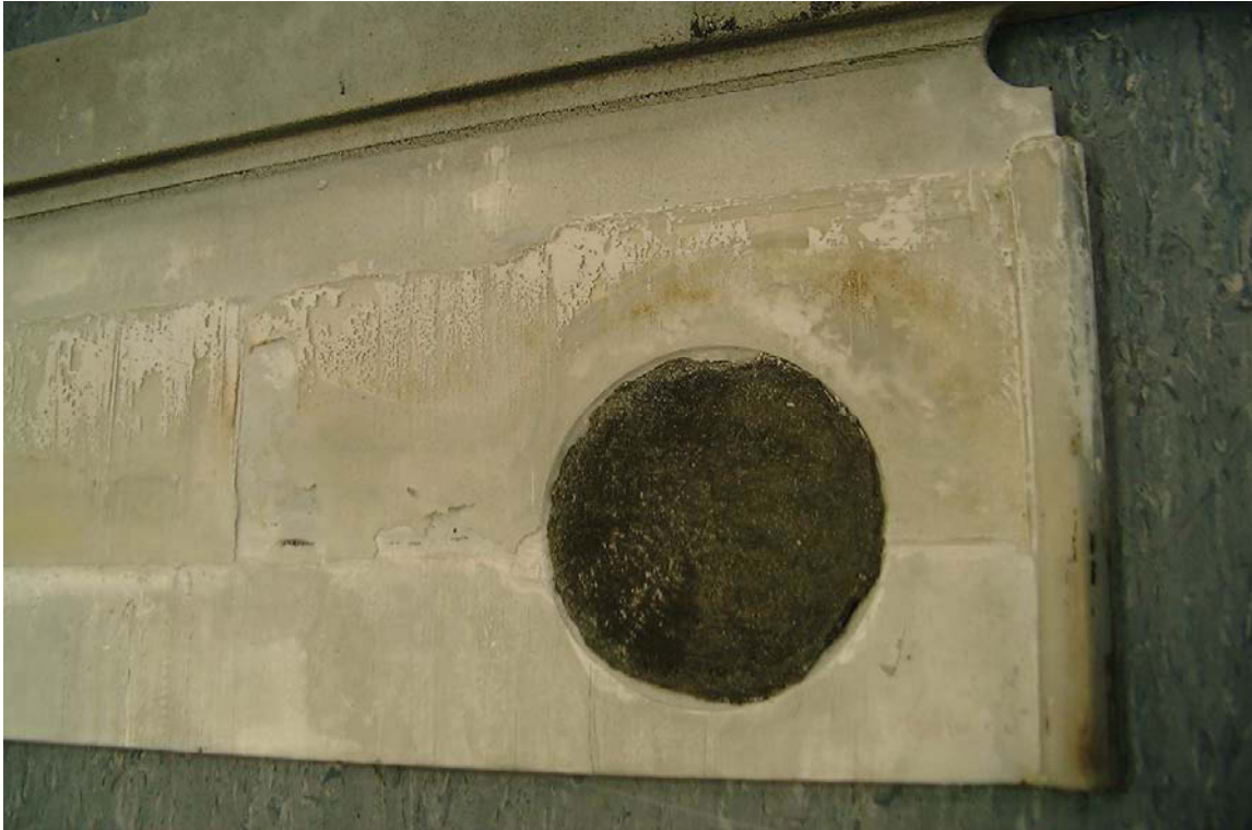
Abbildung 3.11: Abgeschnittenes Kathodenblech mit LZS und Stripphilfe nach siebenmonatigem Einsatz (New Bolida Odda)
