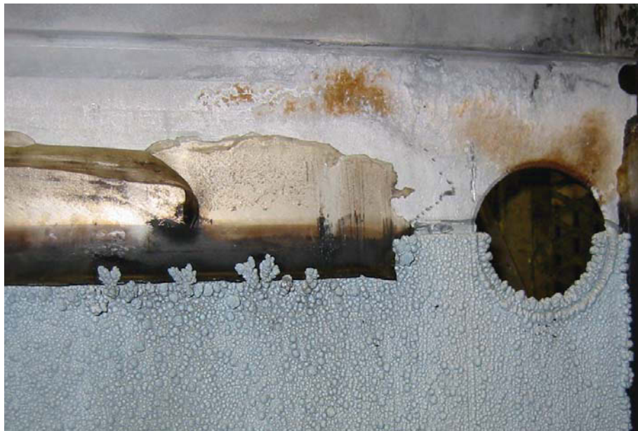
Abbildung 3.8: Abgefallene Stripphilfe (rechte Seite)
