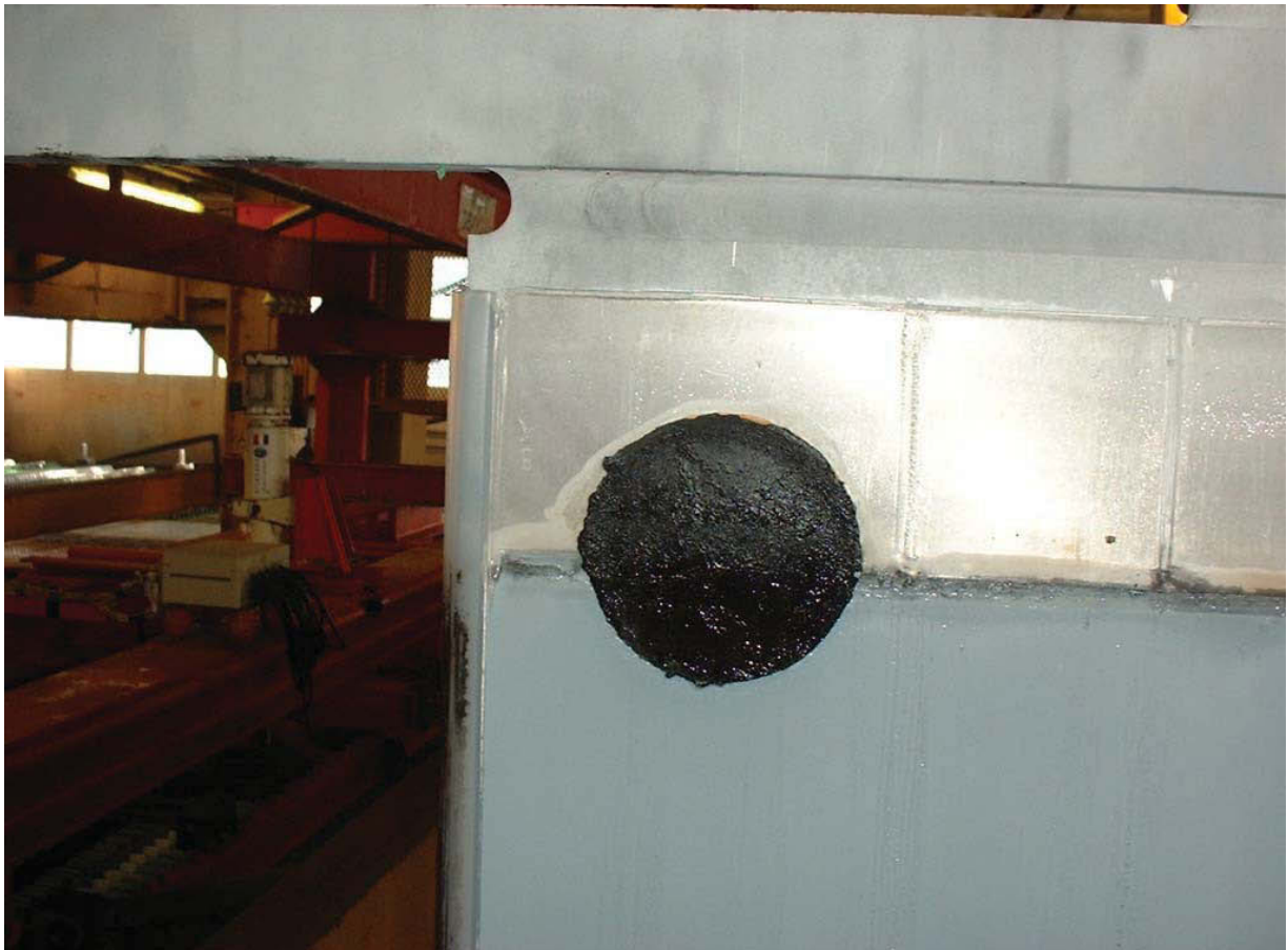
Abbildung 3.10: Kathodenblech mit LZS und Stripphilfe nach siebenmonatigem Einsatz (Boliden Odda, Norzink)
