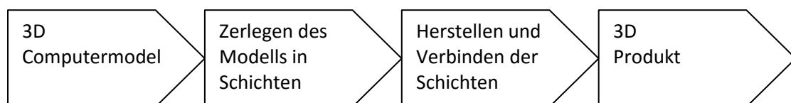
Abbildung 1: Grundlegender Prozessablauf beim Rapid Prototyping [1] [2]
