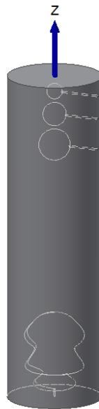
Abbildung 31: Probe P_4 in 3D Ansicht; Hohlstrukturen als dünne Linie
