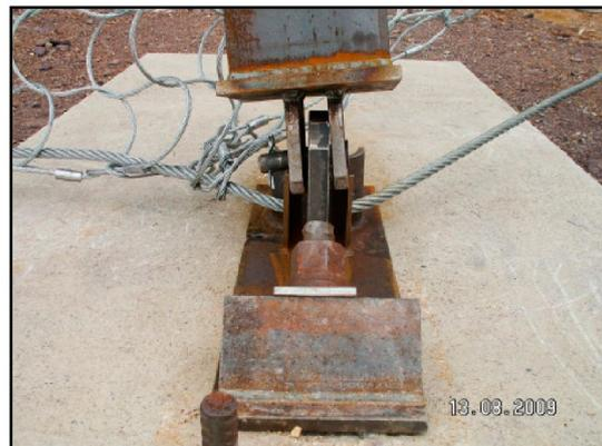
Abbildung 49: Fußgelenk der Stütze 2 nach Versuch
