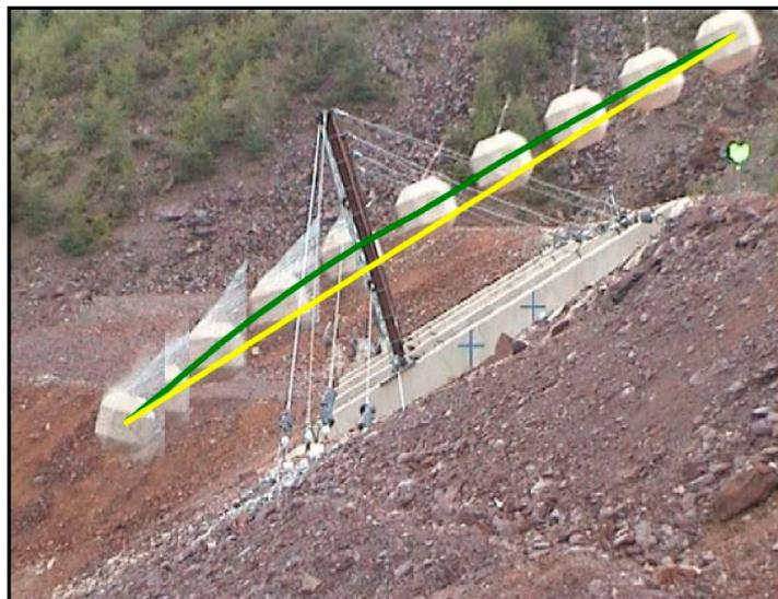
Abbildung 54: Bild der Wurfkörperflugbahn (xz- Ebene)
