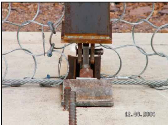
Abbildung 48: Fußgelenk der Stütze 2 vor Versuch
