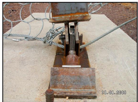
**Abbildung 19: Stützenfuß 2 vor & nach dem Versuch**
