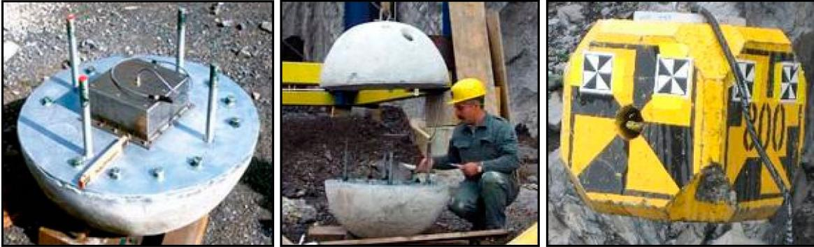
**Abbildung 12: Versuchskörper mit Beschleunigungssensoren [9]**
