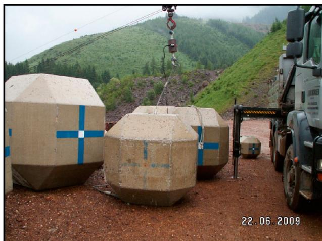
Abbildung 21: Massebestimmung für das System TSC-2000-ZD
