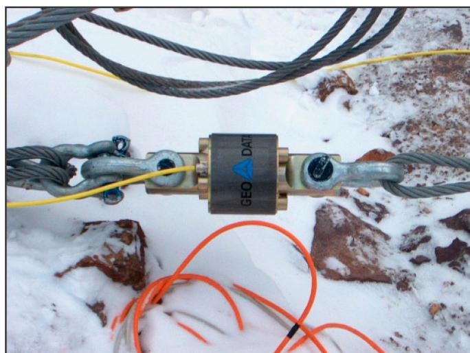
Abbildung 30: Kraftmesszelle
