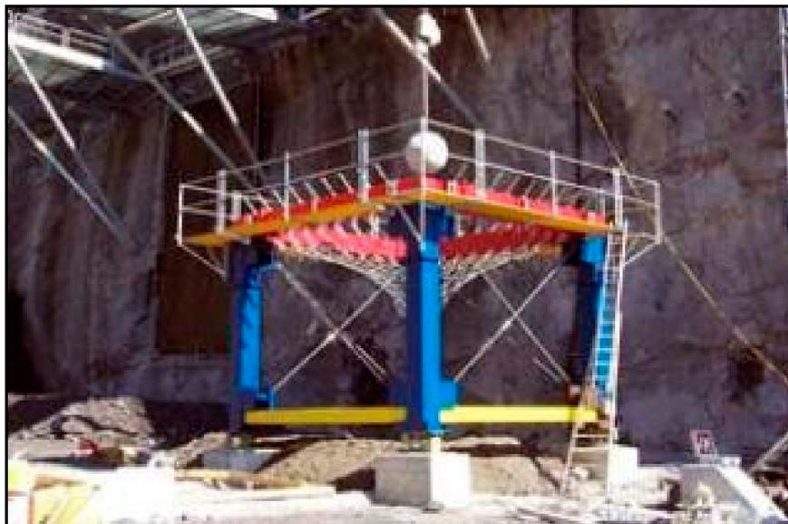
**Abbildung 13: Versuchsrahmen für Komponententests [9]**
