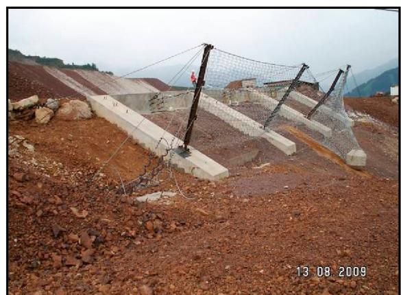
**Abbildung 16: Steinschlagverbauung nach dem Versuch**
