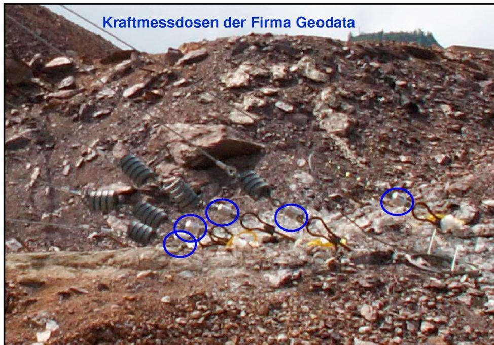
Abbildung 29: Kraftmesszellen für Tragseile
