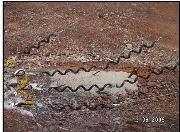
**Abbildung 17: Bremsenlemente vor & nach dem Versuch**
