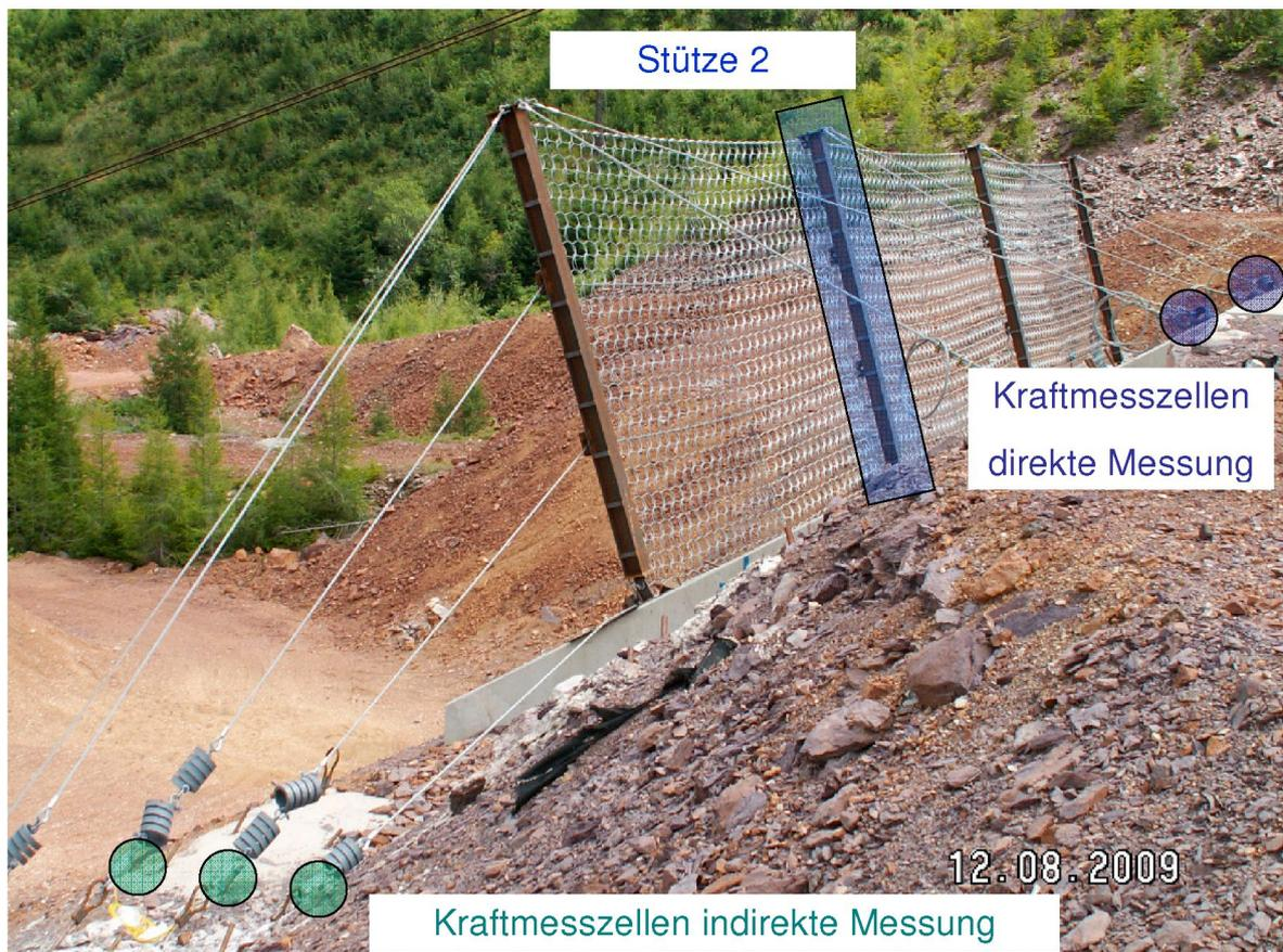
Abbildung 35: Messung der Kräfte direkt / indirekt
