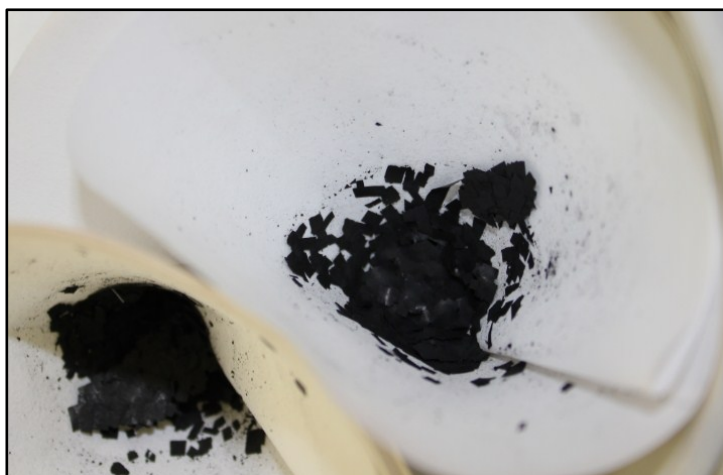
Abbildung 30: Filtrerrückstand nach Abfiltrieren der Aufschlüsse mit dem Originalmaterial
