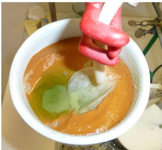
Abbildung 40: Tiefenfilter mit ausgefallenem Feststoff (braun-orange) während der Elektrolyse
