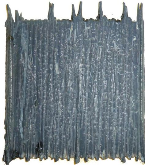
Abbildung 61: Gestripptes Kathodenblech des Langzeitversuches
