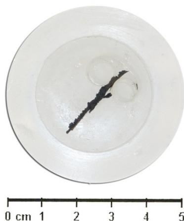
Abbildung 42: Probe in einer Kunststoffhalterung für das senkrechte Einbetten
