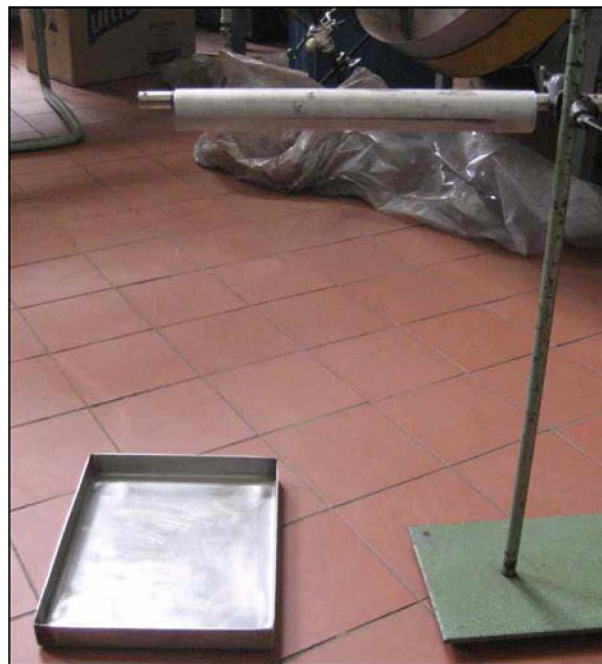
Abbildung 66: Einrichtung zur Bestimmung der Dropfestigkeit
