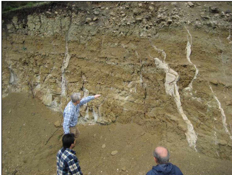
Abbildung 3-6: 2. Probenahestelle; Durch Oberflächenwässer eingedrungenes gelöstes \text{CO}_2 verband sich mit im Bentonit enthaltenen Ca. Die Kluftfüllung besteht demnach aus gefällttem amorphem \text{CaCO}_3 .
