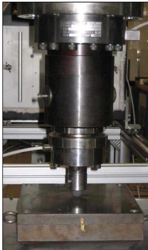
Abbildung 70: Prüfstand zur Messung der Druckfestigkeit am Institut für Gesteinshüttenwesen
