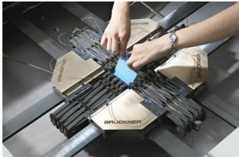
Abbildung 13: Einlegen der Folienprobe in den Verstreckrahmen [18]
