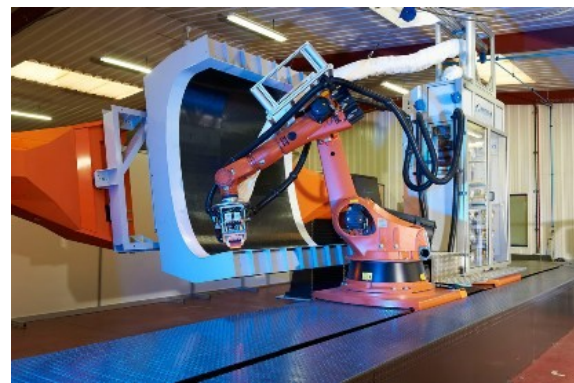
b) Sicht auf die gesamte Roboterzelle (Positionierer, Knickarmroboter samt TLK und Spulengatter).
