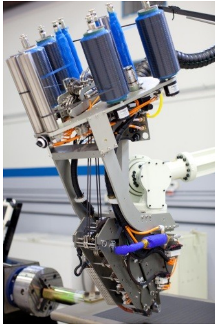
Abbildung 2.17: TLK von ADC mit Multispulenbevorratung im Einsatz beim AMRC an der Universität Sheffield [9].
