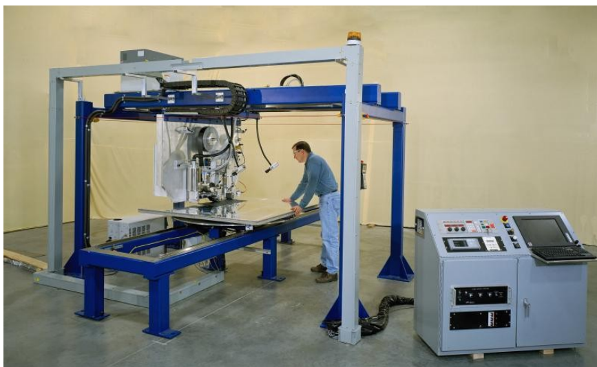
Abbildung 2.12: Komplettes Tapelegesystem von Accudyne Systems [8].
