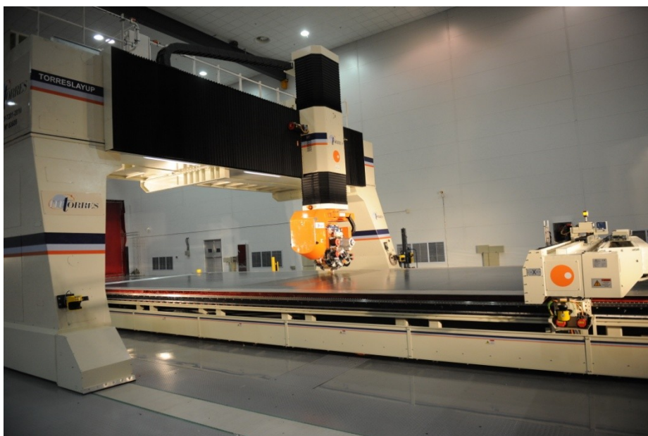
Abbildung 1.2: Komplettes Tapelegesystem des Harbin Hafei Airbus Composite Manufacturing Centre mit Portalanlage und Ablegekopf (Quelle: www.airbus.com ).
