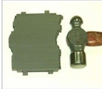
Abbildung 2.13: Flexibles Konsolidierungssystem von Accudyne Systems, das die Kontur eines Hammers nachbildet [8].
