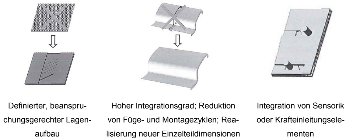
Abbildung 2.7: Einige Vorteile des automatisierten Tapelegeverfahrens [4].
