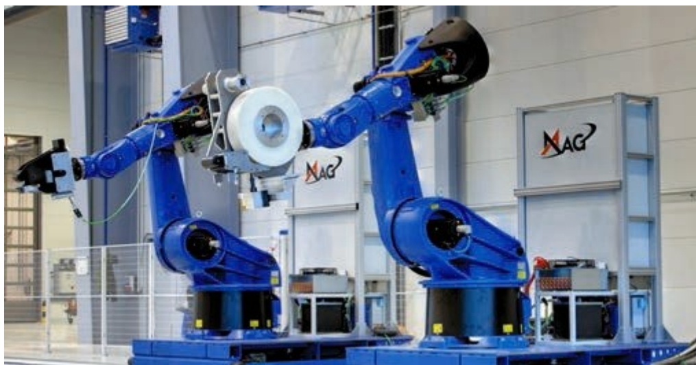
Abbildung 2.16: Kooperative Robotereinheiten für simultanen und hochdynamischen Ablegeprozess [12].
