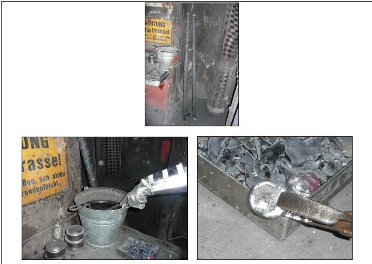
**Abbildung 3- 3:** Stahlprobennachbearbeitung
