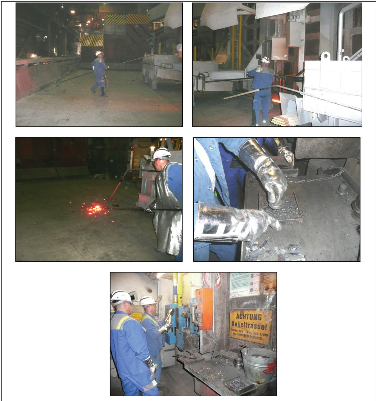
**Abbildung 3- 4:** Schlackenprobennahme
