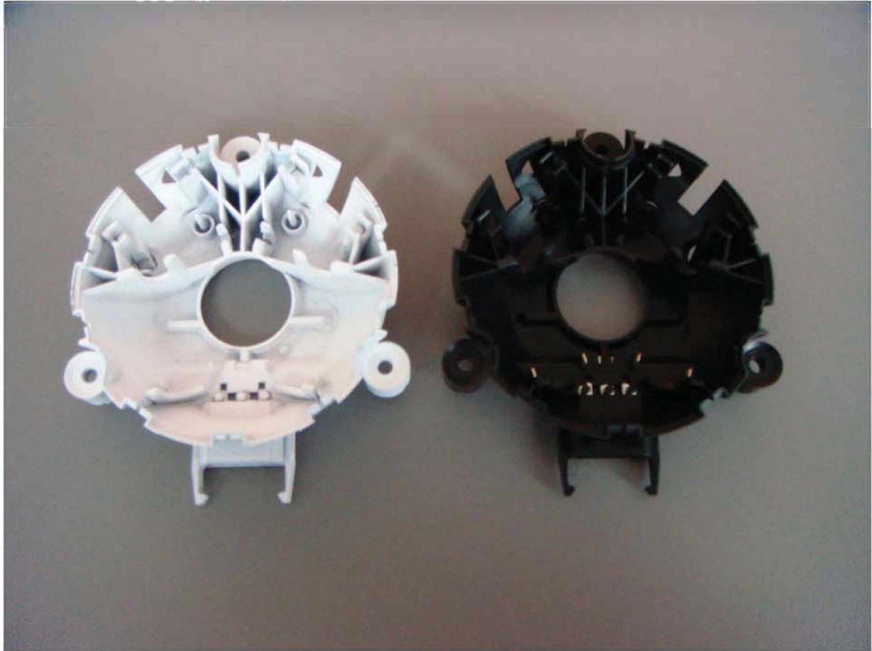
Bild 11: Vergleich eines mit Entwickler zur Kontrasterhöhung eingesprühten Bauteils (links) und eines unbehandelten Bauteils (rechts)
