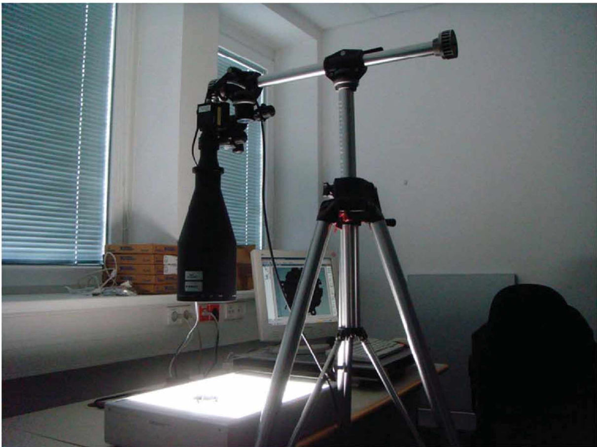
Bild 16: Telezentrischer Messaufbau mit Durchlichttisch und darüber positioniertem Objektiv mit Kamera
