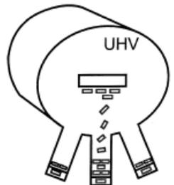
Abbildung 3: Herstellung molekularer Schichten [8]
