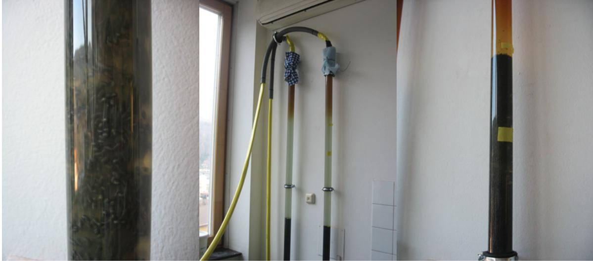
Abbildung 5.5: Säulen mit durchströmter Schüttung
