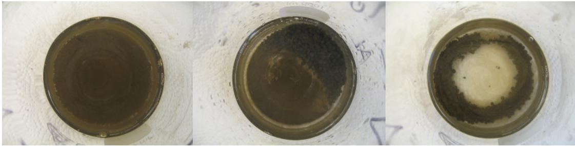
Abbildung 5.2: Absetzende Trübe (Korrosionsprodukte, Präzipitate)
