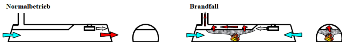
Abbildung III-6: Längslüftung mit Rauchgasabsaugung [31]
