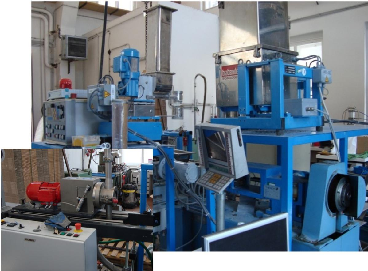
*Abbildung 22: Doppelschneckencompounder TSK30/40D, Fa. Theyson, Deutschland mit Unterwassergranulierungsmaschine EUP100L, Fa. ECON GmbH, Österreich*
