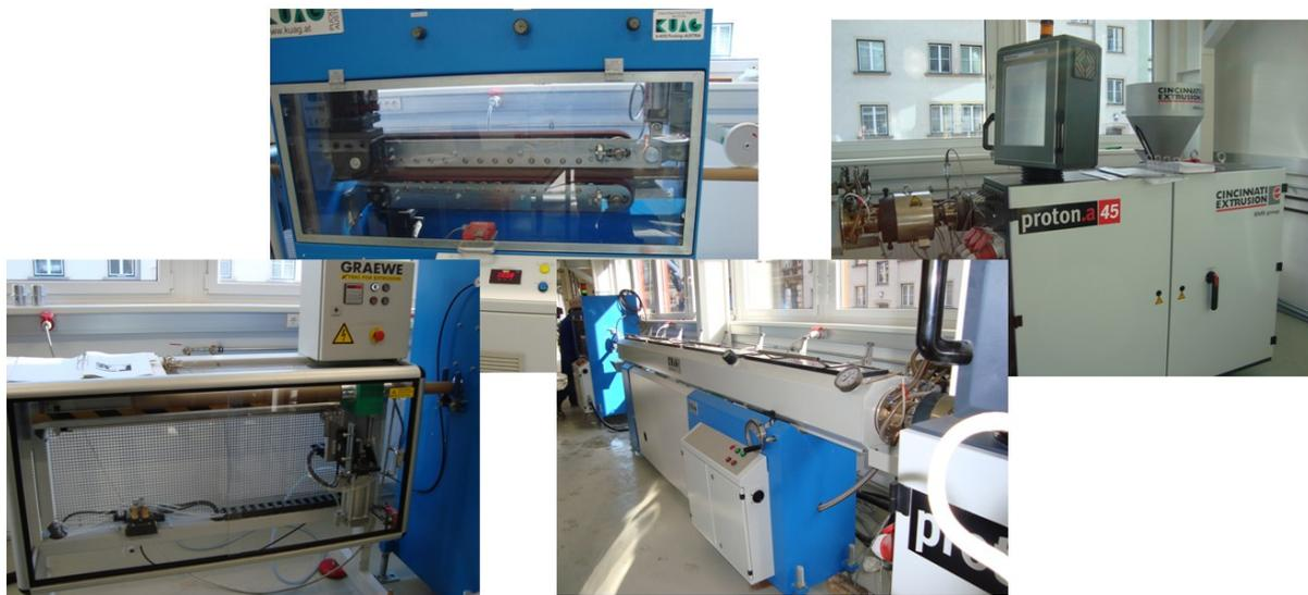
*Abbildung 34: Rohrextrusionsanlage des Institutes für Kunststoffverarbeitung der Montanuniversität Leoben*
