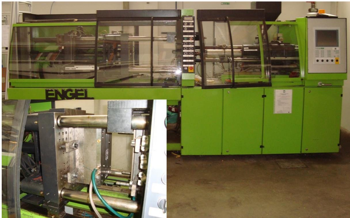
Abbildung 27: Spritzgießmaschine Engel ES330/80H mit einem Zweiplattenwerkzeug.
