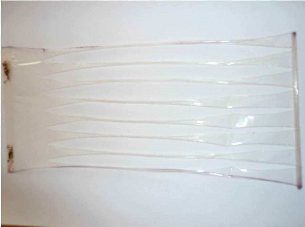
**Abb. 4.48:** Eingerolltes Europlex (Test 1).
