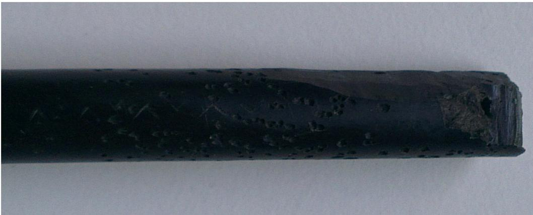
Abbildung 4.14: Probe mit Hohlräumen bei Messung 2.
