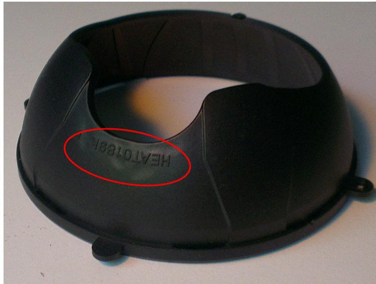
**Abbildung 3.9:** Bauteil mit Einfallstellen.
