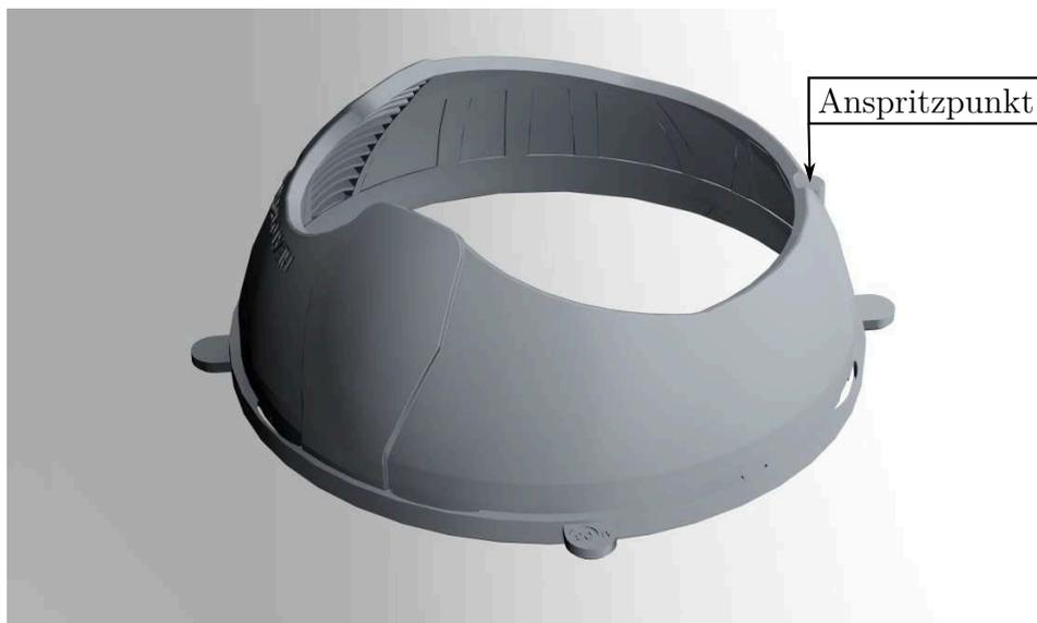
**Abbildung 3.1:** Bauteil „Antriebsschale“.
