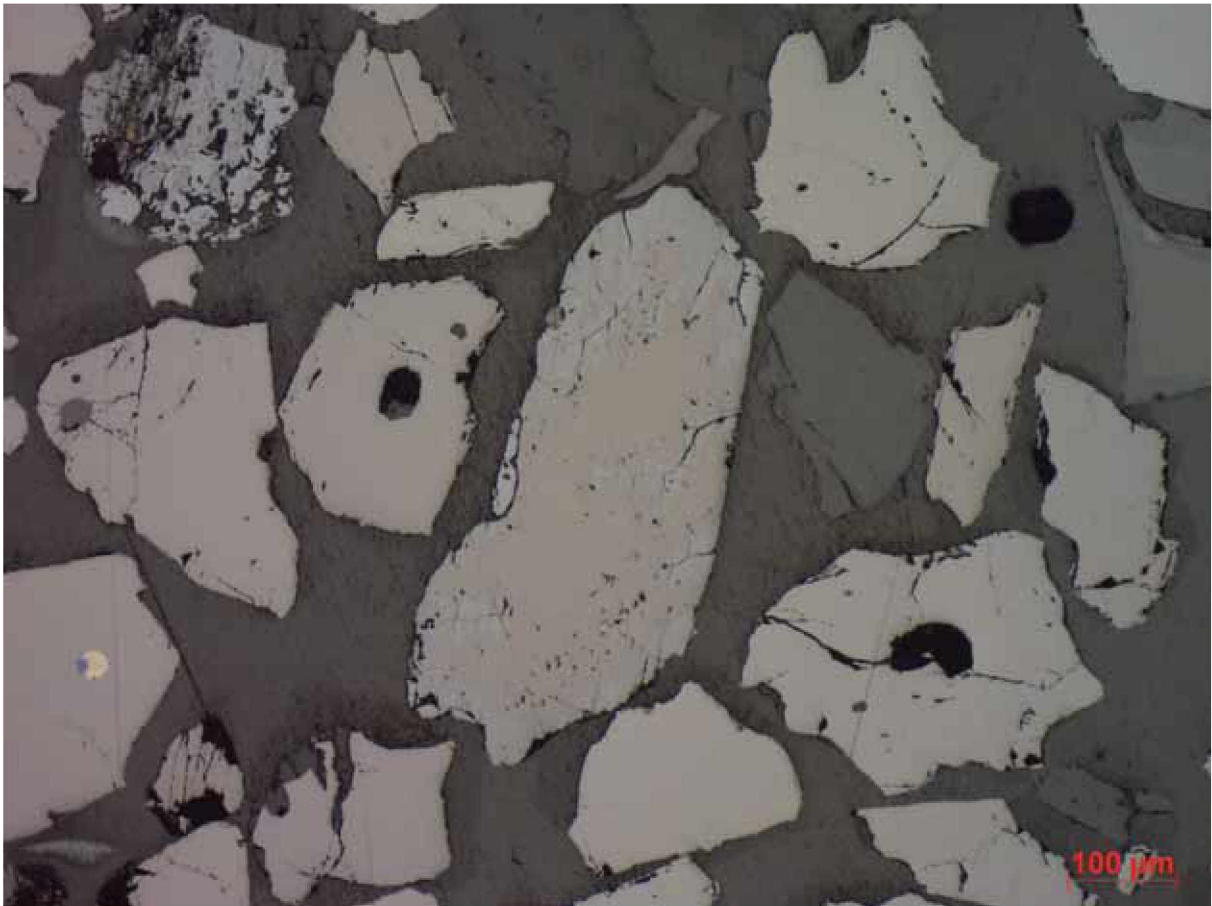
Abb. 13: Ilmenit (großes Korn Bildmitte) mit beginnender Alteration zu Pseudorutil am Rand und entlang von Mikrorissen; 10fache Vergrößerung, Nicols parallel, Korn 01A11 (Foto: 01A11_10IIN2_m - Arbeitskopie 2.jpg).
