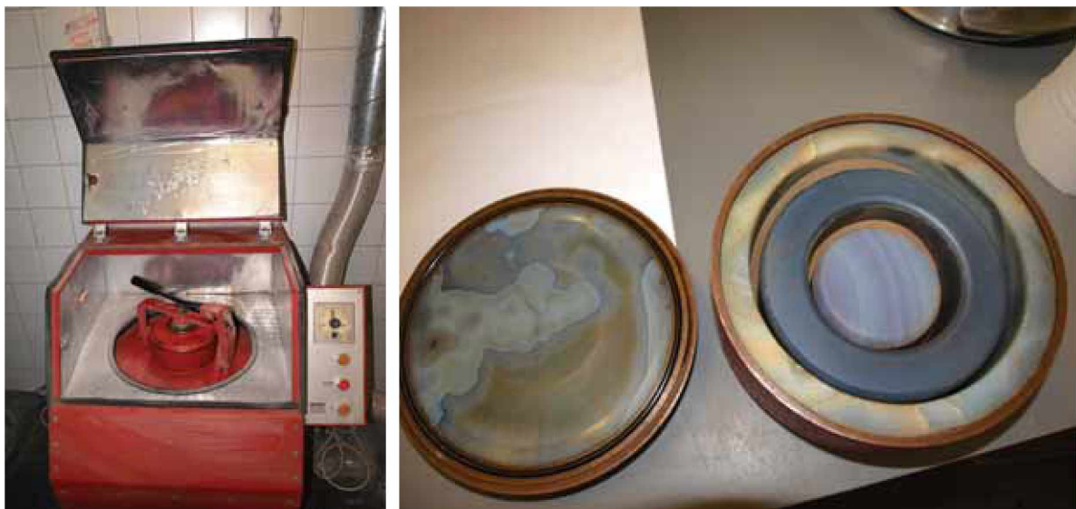
Abb. 10: Scheiben-Schwingmühle Pulverisette 9 der Firma Fritsch und Mahlgarnitur aus Achat mit Quarzsand zur Reinigung.
