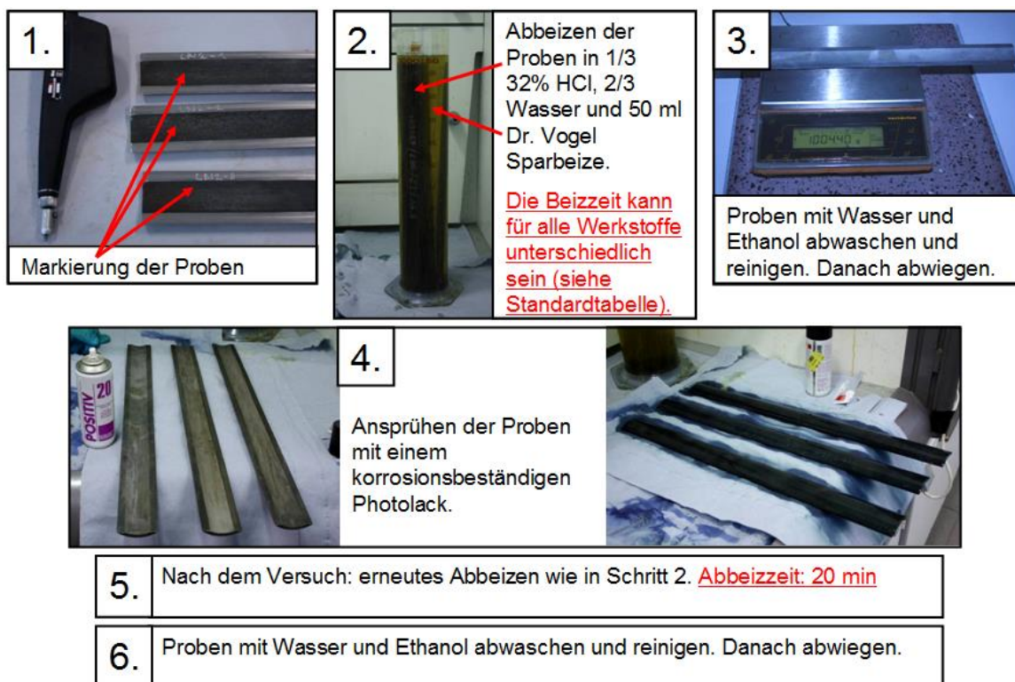
Abb. 4.9: Abfolge der Präparationsschritte der Rohrsegmente (Ankoppelungen werden ohne Schritt 2 vorbehandelt)
