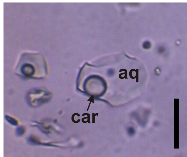
Abb. 5.2, gashältiger Flüssigkeitseinschluss der Gruppe 1. mit relativ kleiner Blase (ca. 15 Volumsprozent) in Quarz (aq = wässrige Lösung, car = Gasmischung von \text{H}_2\text{O} , \text{CO}_2 , \text{N}_2 , \text{CH}_4 und \pm \text{H}_2\text{S} ), Balkenlänge entspricht 10 \mu\text{m}
