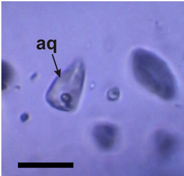
a, tropfenförmiger Flüssigkeitseinschluss in Kalzit (Blasengröße ca. 6 Volumsprozent), Balkenlänge entspricht 10 \mu\text{m}
