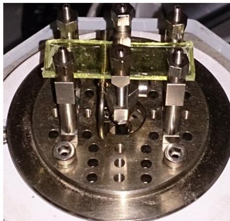
**Abbildung 3.4:** Messaufbau für die DMA Untersuchungen.
