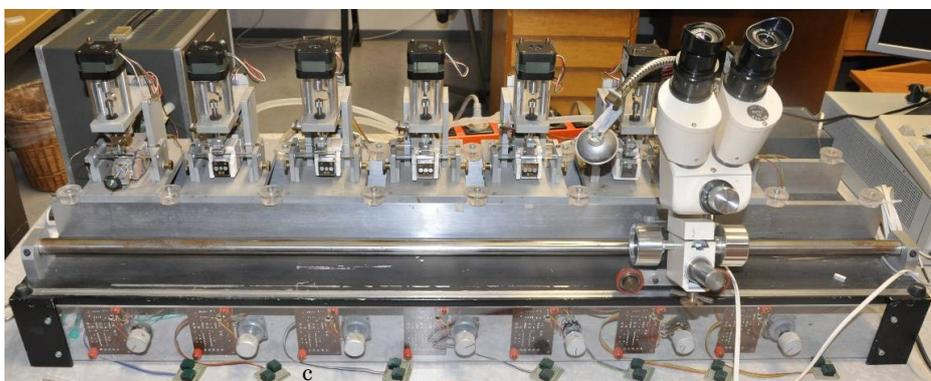
**Abbildung 3.5:** Apparatur zum Einbetten von sieben Glasfasern in die Epoxidharzmatrix für die Faserausziehversuche.
