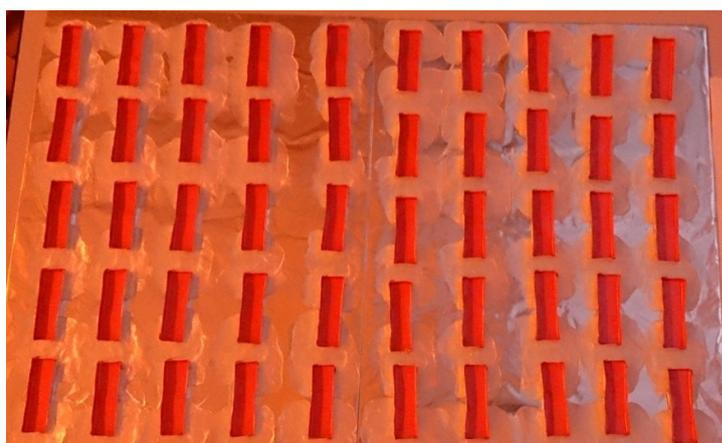
**Abbildung 3.3:** Probeschalen zur Herstellung der DMA Prüfkörper.
