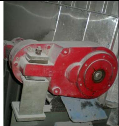
4x Getriebemotor antriebseitig pro Linie:
