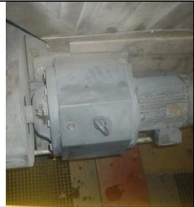
1x Getriebemotor Zellenrad pro Linie:
